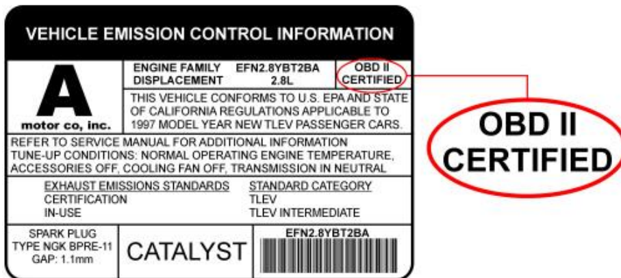
Σχήμα 4.2 Ετικέτα αυτοκινήτου για πιστοποίηση χρησιμοποίησης OBD-II
