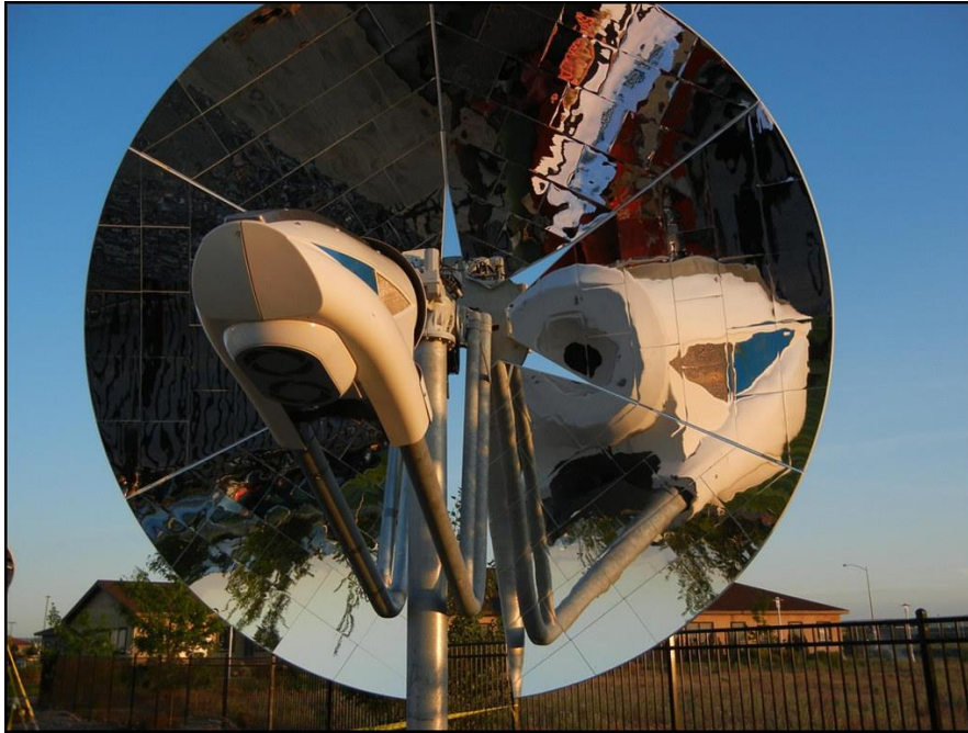
Σχήμα 1.3. NatGas-Dish CSP. Ηλιακός συλλέκτης της NASA εγκατεστημένος στην έρημο της Νεβάδα.
