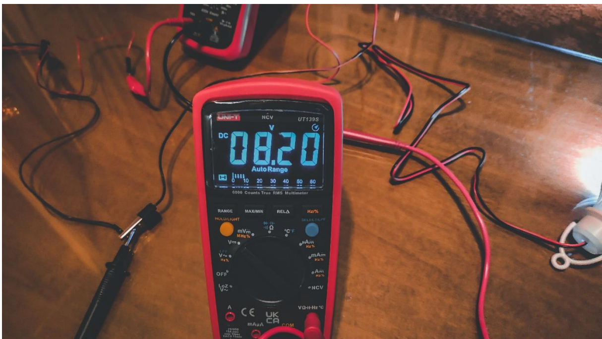
Σχήμα 3.43. Φωτογραφία της τάσης εξόδου της γεννήτριας με φορτίο λαμπτήρα
