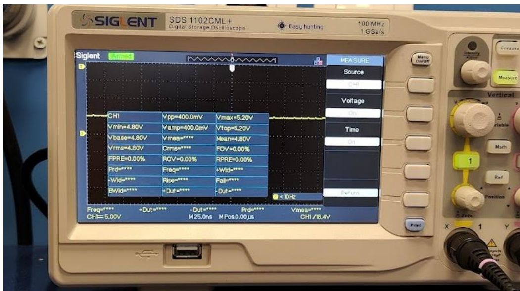
Σχήμα 3.25. Μέτρηση τάσης εξόδου με παλμογράφο χωρίς φορτίο
