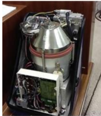
Σχήμα 2.2. Σύστημα Micro-CHP με κινητήρα Stirling.
