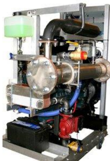
Σχήμα 2.3. Σύστημα Micro-CHP με κινητήρα εσωτερικής καύσης.
