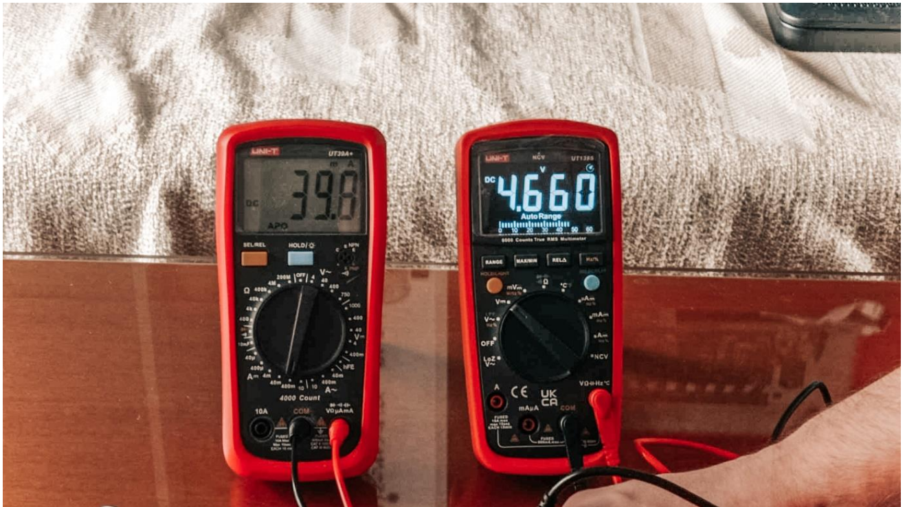
Σχήμα 3.46. Μετρήσεις εξόδου γεννήτριας με φορτίο κινητό τηλέφωνο
