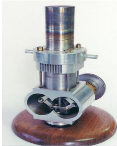
Σχήμα 1.8. Μηχανή Stirling τύπου Gamma.
