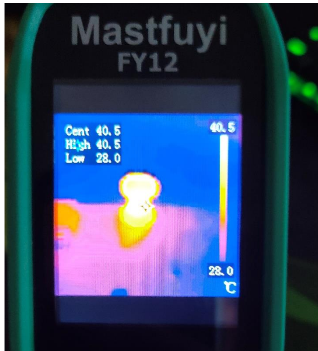
Σχήμα 3.40. Φωτογραφία θερμοκάμερας μετά απο 3 λεπτά τροφοδότησης του Buck Converter
