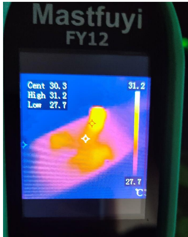
Σχήμα 3.38. Φωτογραφία θερμοκάμερας κατά την έναρξη τροφοδότησης του Buck Converter
