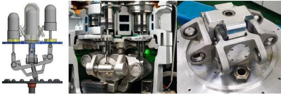
Σχήμα 1.12. Μηχανισμός κίνησης Wooble Plate κινητήρα Stirling.
