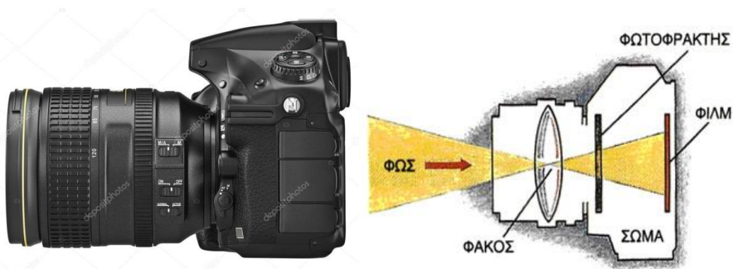
Εικόνα 5: Παράδειγμα λειτουργίας κάμερας
