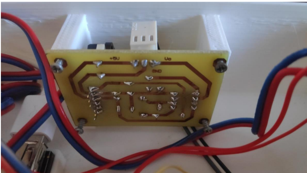
Σχήμα 6.4 Πλακέτα για το αισθητήριο πίεσης MPX5050GP (Κύκλωμα ενίσχυσης και χαμηλοπερατού φίλτρου 1 ης Τάξης, σχηματικό διάγραμμα στο Σχ. 3.3)
