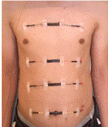
Σχήμα 1.4 : Μέθοδος μέτρησης αναπνοής με την χρήση τεσσάρων resistive strain gauge τοποθετημένα στο σώμα του ασθενή
