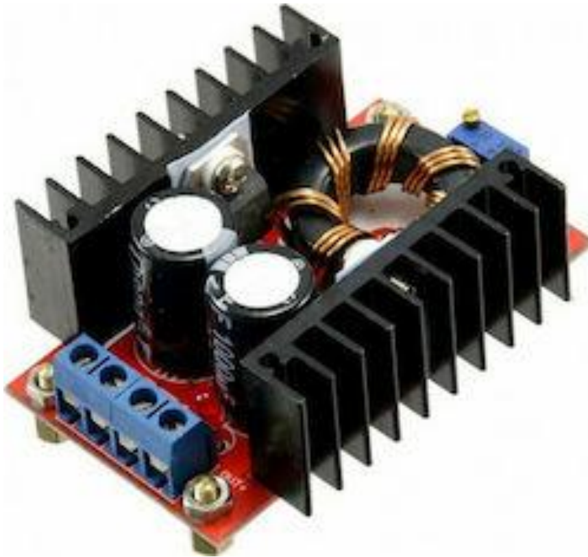
Εικόνα 2.6 Μετατροπέας 150w dc-dc 12 σε 24v [12]
