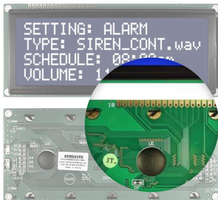
Εικόνα 2.20 Οθόνη lcd 4x20 NHD-0420E2Z-NSW-BBW [19]
