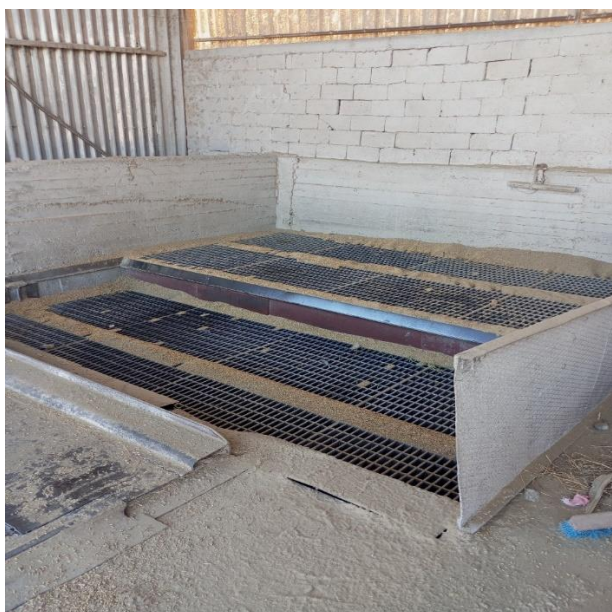
Εικόνα 4.1: Διάταξη παραλαβής πρώτης ύλης.
