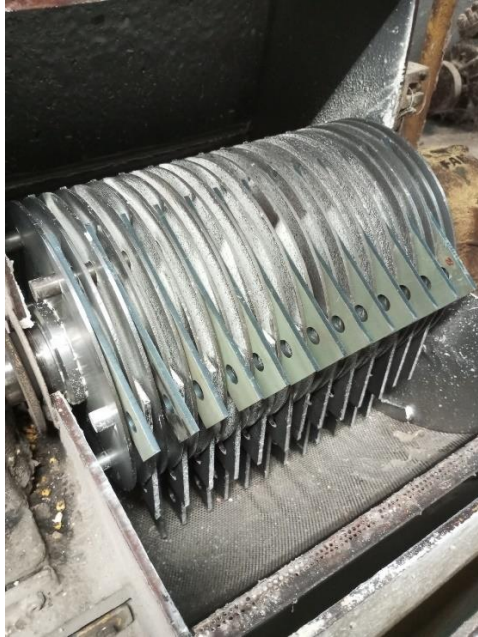
Εικόνα 4.6: Εσωτερικό μύλου άλεσης φαίνονται τα μαχαίρια και κατω το κόσκινο.
