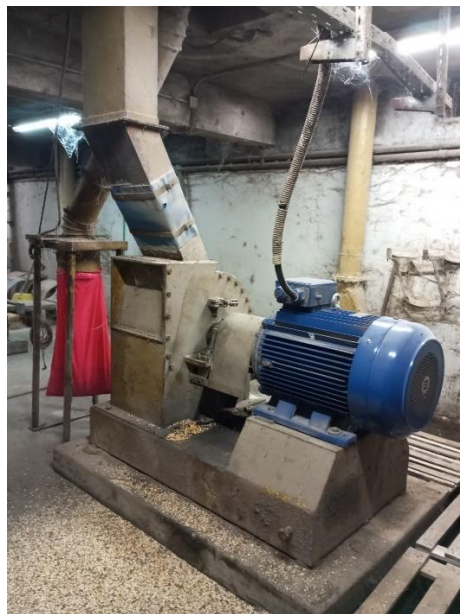
Εικόνα 4.5: Σφυρόμυλος άλεσης δημητριακών με αερομεταφορά.
