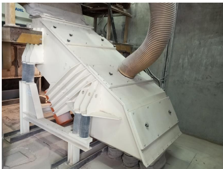
Εικόνα 4.17: Κόσκινο διαχωρισμού Pellet από σκόνη .
