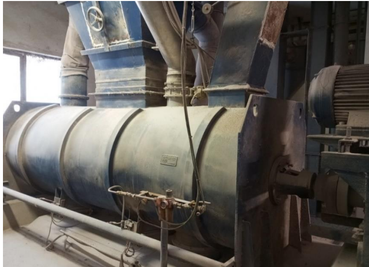
Εικόνα 4.8: Μίξερ βιταμινών και ιχνοστοιχείων για την δημιουργία προμείγματος.
