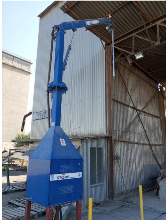
Εικόνα 4.2: Δειγματολήπτης αραβόσιτου με ρομποτικό βραχίονα και αερομεταφορά.
