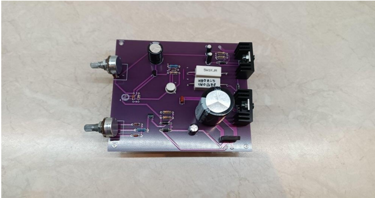
Σχήμα 10.3 Πλακέτα του τροφοδοτικού με τοποθετημένα τα εξαρτήματα επάνω.
