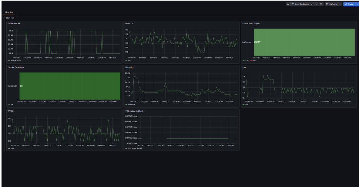
Σχήμα 3.4: Το τελικό Grafana dashboard με τα οκτώ panels παρακολούθησης σε πραγματικό χρόνο.
