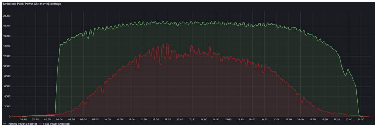
Σχήμα 5-13: Ημερήσια παραγωγή ενέργειας tracking και fixed συστήματος για ημέρα με αυξημένη ηλιοφάνεια για τη μέρα 29/05/2026
