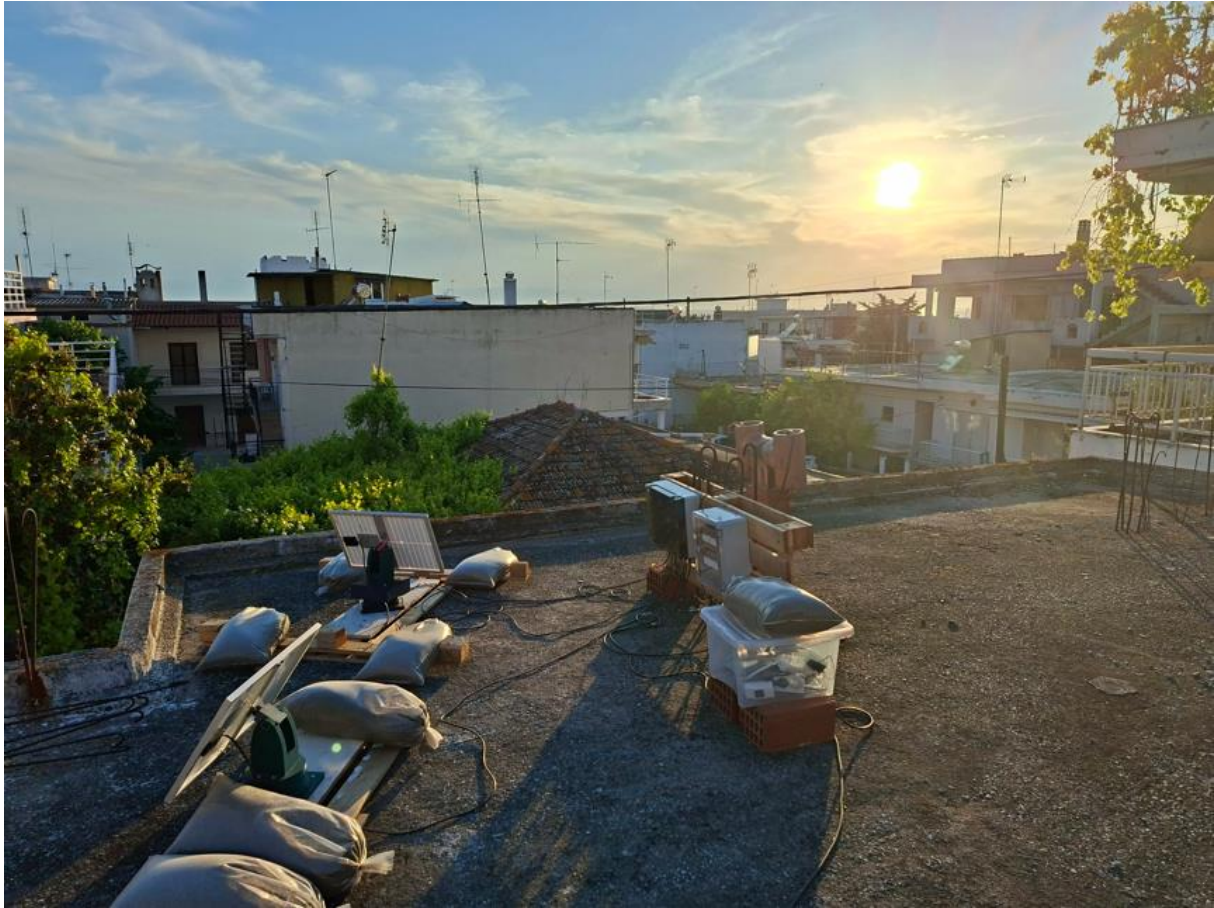
Σχήμα 4-36: Τελική εγκατάσταση του συστήματος με το fixed και το tracking φωτοβολταϊκό πλαίσιο
