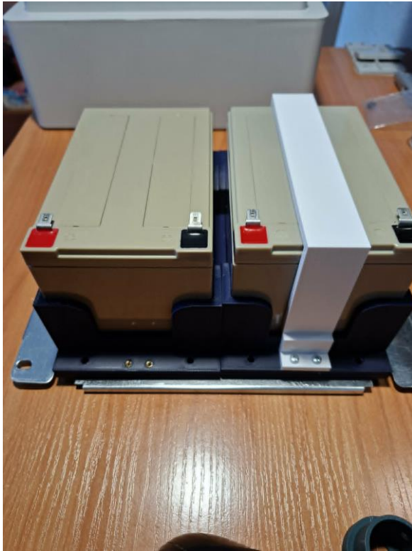
Σχήμα 4-9: Στήριξη μπαταριών με 3D printed βάσεις
