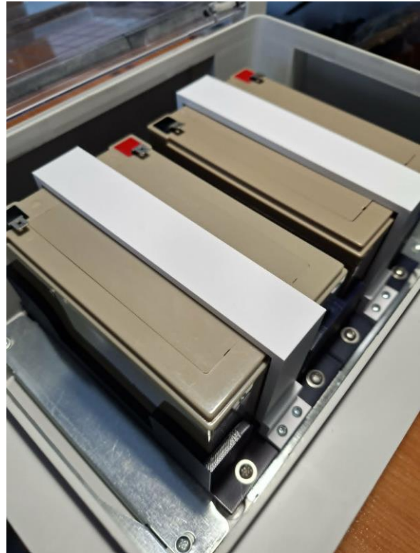
Σχήμα 4-9: Στήριξη μπαταριών με 3D printed βάσεις
