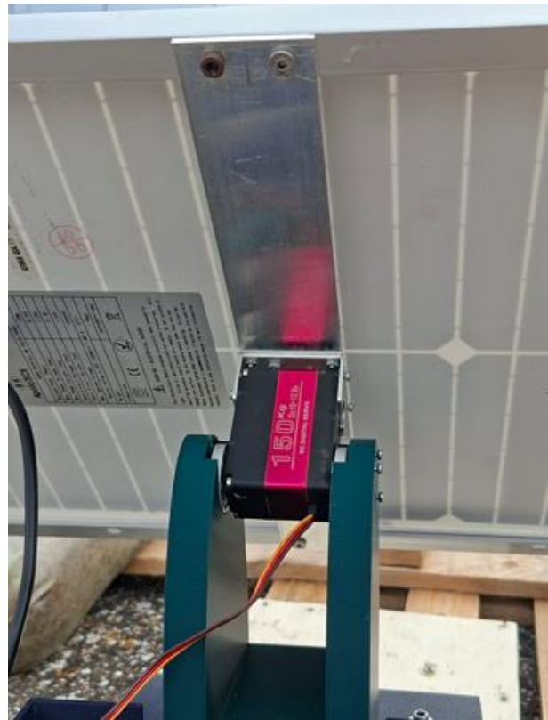
Σχήμα 4-19: Τοποθέτηση κινητήρων στις 3D printed βάσεις
