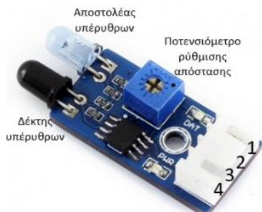
Σχήμα 3.9. Αισθητήρας ανίχνευσης αντικειμένου με υπέρυθρες ακτίνες - μπροστινή όψη
