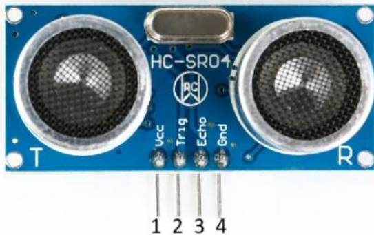
Σχήμα 3.8. Αισθητήρας μέτρησης απόστασης με υπέρηχους - μπροστινή όψη
