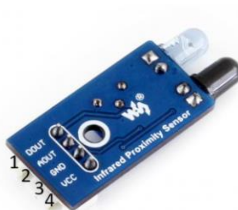
Σχήμα 3.10. Αισθητήρας ανίχνευσης αντικειμένου με υπέρυθρες ακτίνες - πίσω όψη
