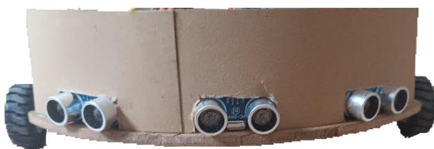
Σχήμα 7.21. Μπροστινό μέρος σκούπας με αισθητήρες υπέρηχων
