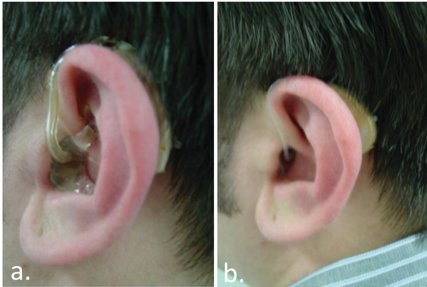
Σχήμα 2.4 a. Ακουστικό βαρηκοΐας τύπου Behind The Ear (BTE) που προσαρμόζεται στο αυτί με ειδικά φτιαγμένο καλούπι b. Ακουστικό βαρηκοΐας τύπου Mini BTE που εφαρμόζει την ανοιχτή εφαρμογή στο κανάλι [25]
