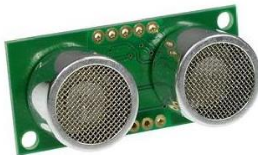
Εικόνα 1.9. Ενεργητικός αισθητήρας υπερήχων.
