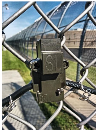
Εικόνα 1.14. Αισθητήρας δονήσεων φράκτη.
