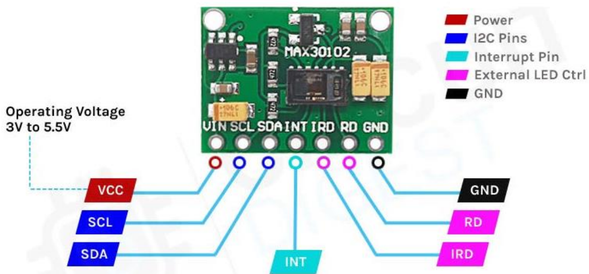
Εικόνα 40 Το αισθητήριο MAX30102 και οι ακροδέκτες του [33]
