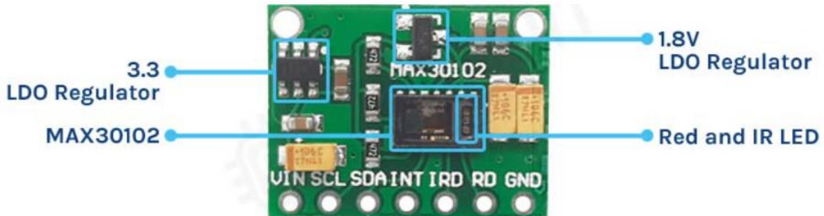
Εικόνα 41 Η ολοκληρωμένη πλακέτα MAX30102 [33]
