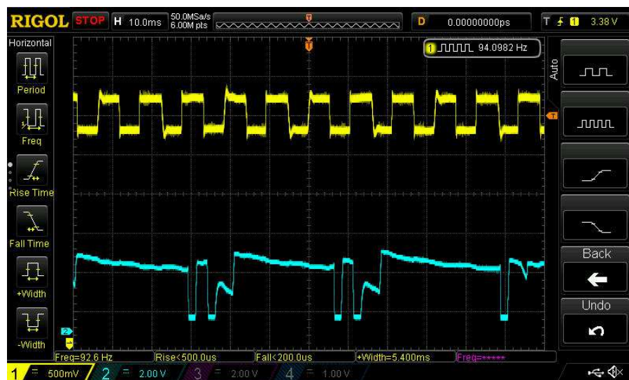
Εικόνα 38. Ρύθμιση Delay Low και echo Echo Repeat Low
