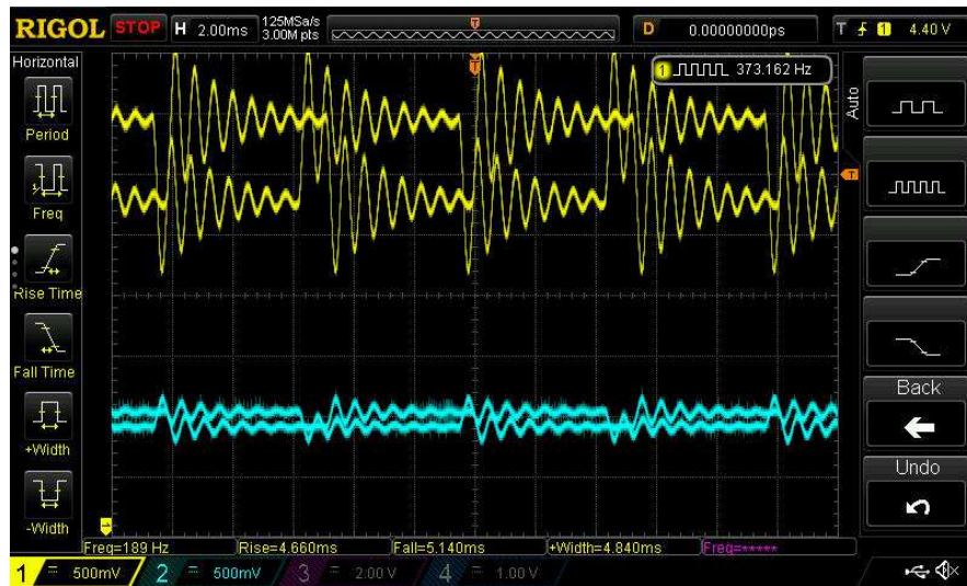
Εικόνα 37. Η κυματομορφή εισόδου στον PT2399 (πάνω) και το σήμα εξόδου (κάτω).
