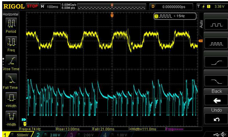
Εικόνα 40. Ρύθμιση Delay high και Echo Repeat High
