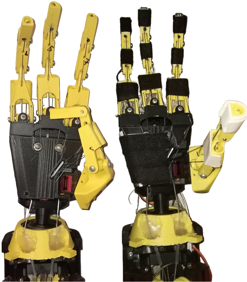
Εικόνα 2.8. Αρπάγη ρομποτικού βραχίονα αριστερά χωρίς επένδυση, δεξιά με επένδυση.
