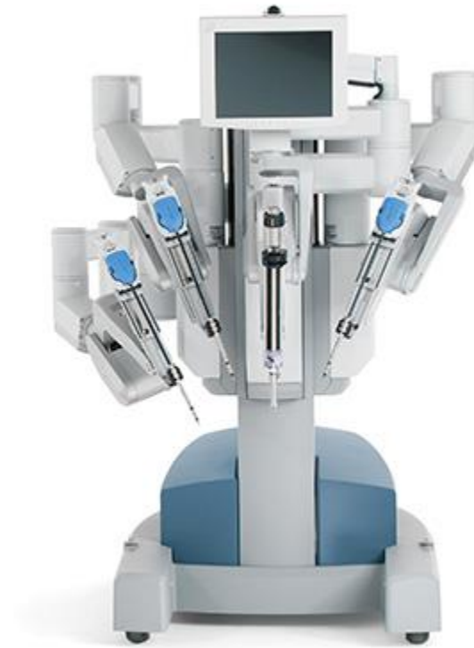
Εικόνα 1.1. Χειρουργικό Σύστημα da Vinci® [14].
