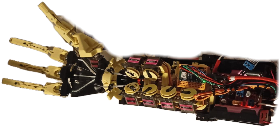
Εικόνα 2.13. Μηχανική δομή ρομποτικού βραχίονα.
