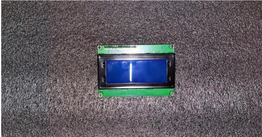
Εικόνα 3.8 – Οθόνη 20 χαρακτήρων και 4 γραμμών
