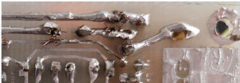
Εικόνα 4.2.1 : Αποκατάσταση κατεστραμμένης λεπτής όδευσης
