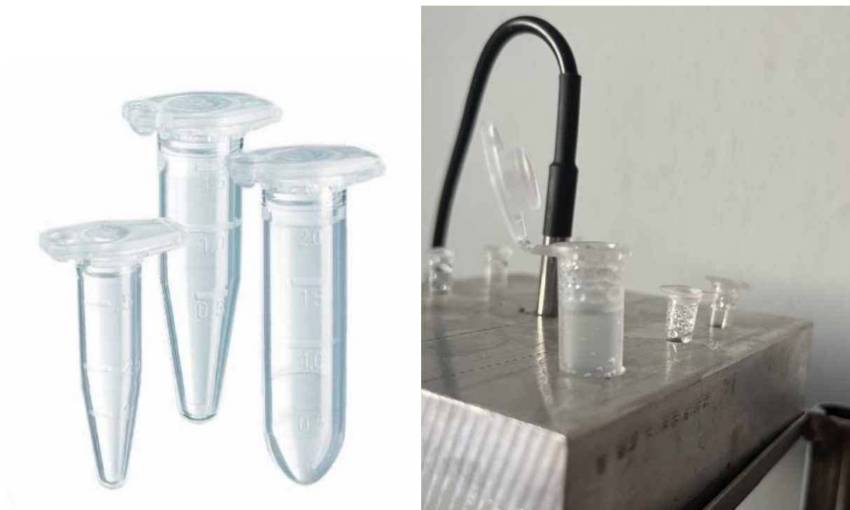
Εικόνα 3.4 [12]Τα vials με υδρατμούς λόγω της θέρμανσης της μεταλλικής πλάκας
