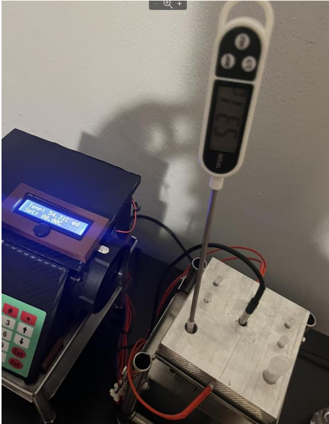
Εικόνα 3.13 Ένδειξη θερμοκρασίας με διαφορετικό θερμόμετρο καθώς η συσκευή είναι σε λειτουργία
