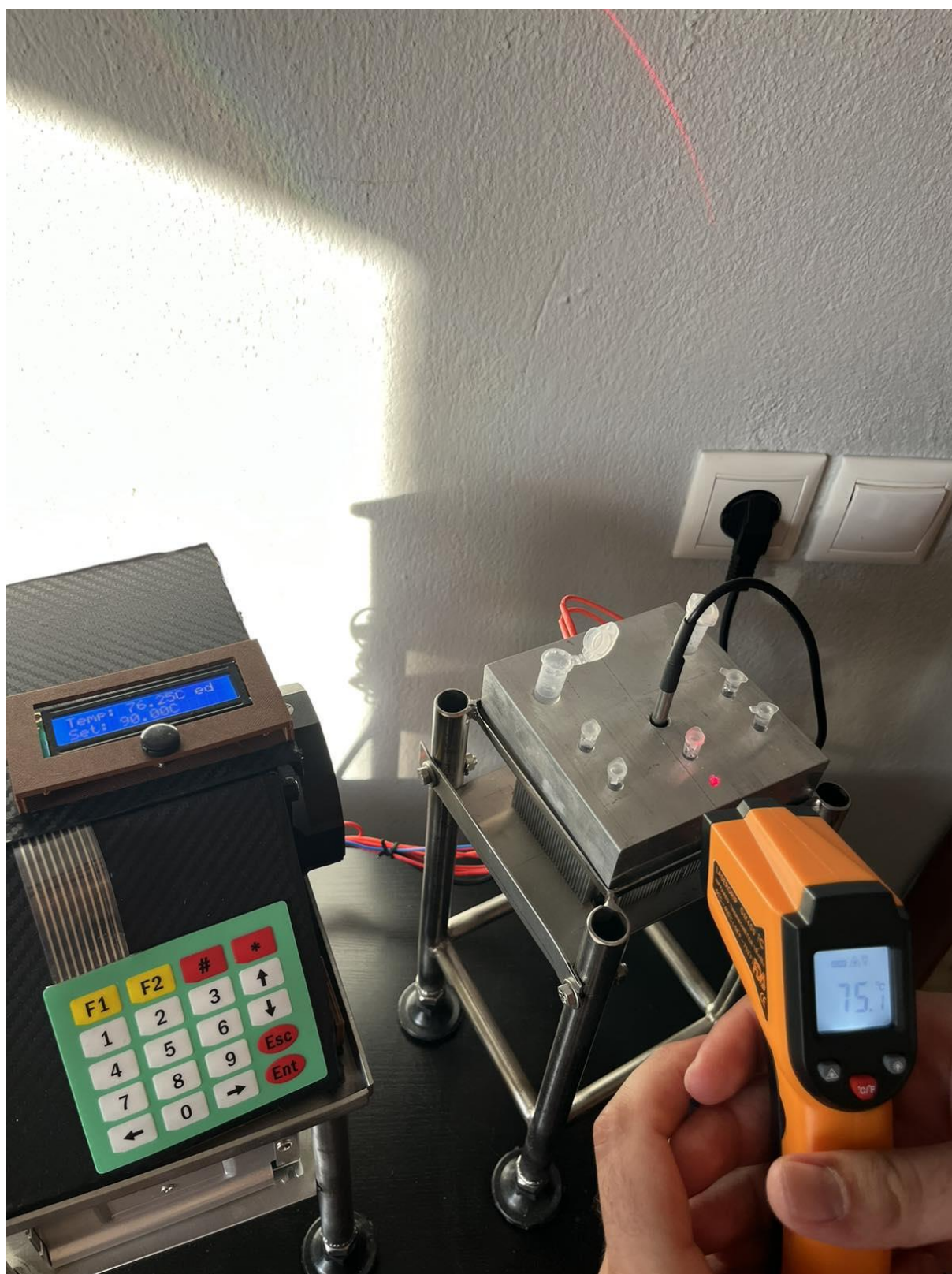
Εικόνα 3.13 Ένδειξη θερμοκρασίας με ψηφιακό θερμόμετρο καθώς η συσκευή είναι σε λειτουργία
