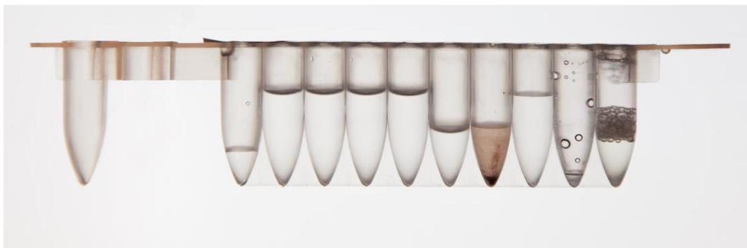
Εικόνα 1.3 Κασέτα με προδιανεμημένα αντιδραστήρια. Η κασέτα περιέχει όλα τα απαραίτητα αντιδραστήρια για τη διαδικασία απομόνωσης του DNA και χρησιμοποιείται σε συνδυασμό με αυτόματα συστήματα απομόνωσης νουκλεϊκών οξέων [1]
