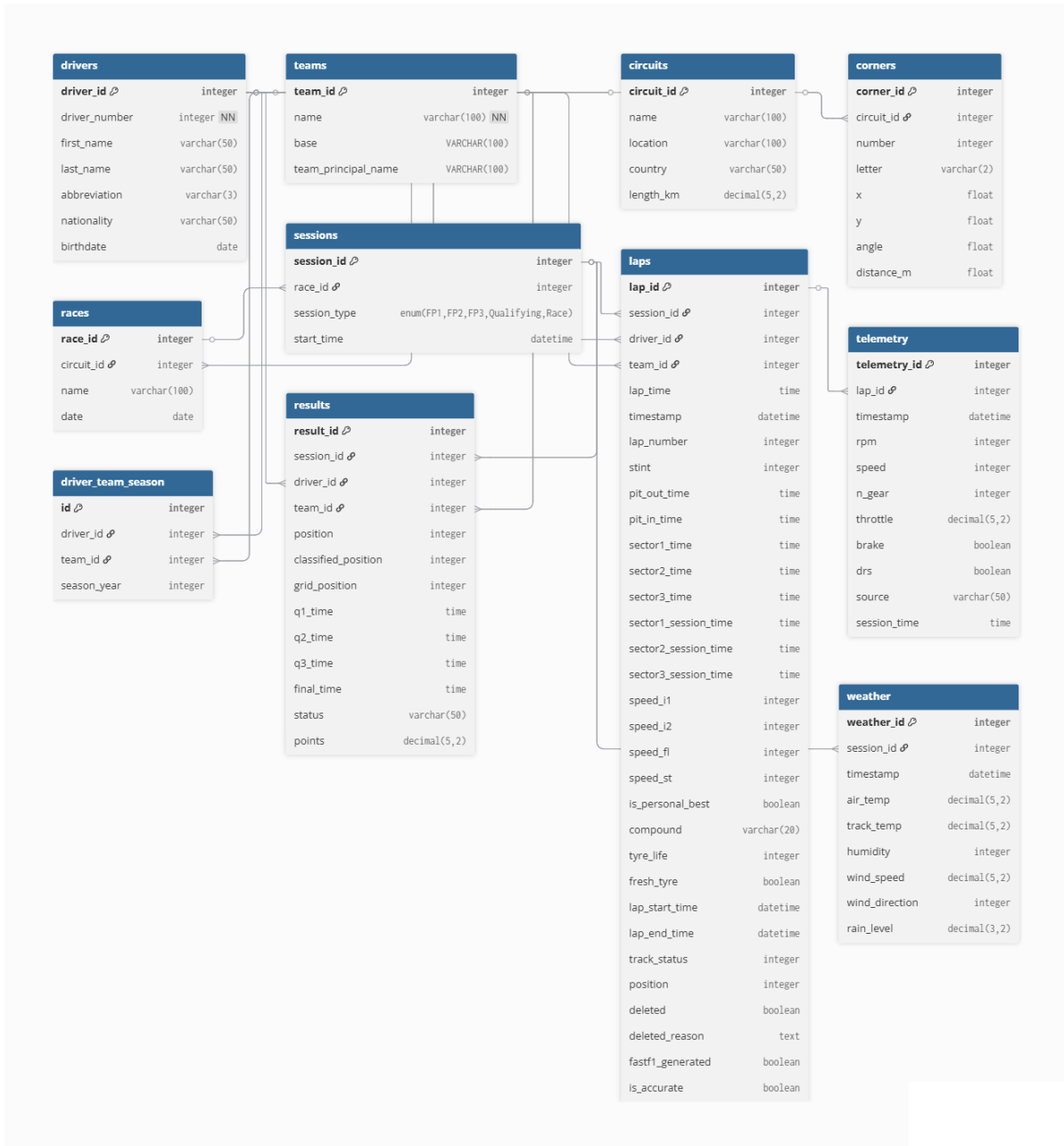
Σχήμα 4.3: ER Diagram της Βάσης Δεδομένων
