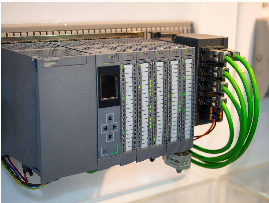
Εικόνα 1.3 - Έλεγχος βιομηχανικών μηχανών υψηλής τεχνολογίας μέσω PLC που προγραμματίζει λογικό έλεγχο για την κατασκευή
