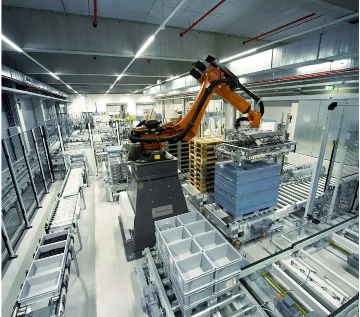
Εικόνα 2.2 - Αυτοματοποιημένα Συστήματα Παλετοποίησης & Αποπαλετοποίησης | Toyota Automated Logistics
