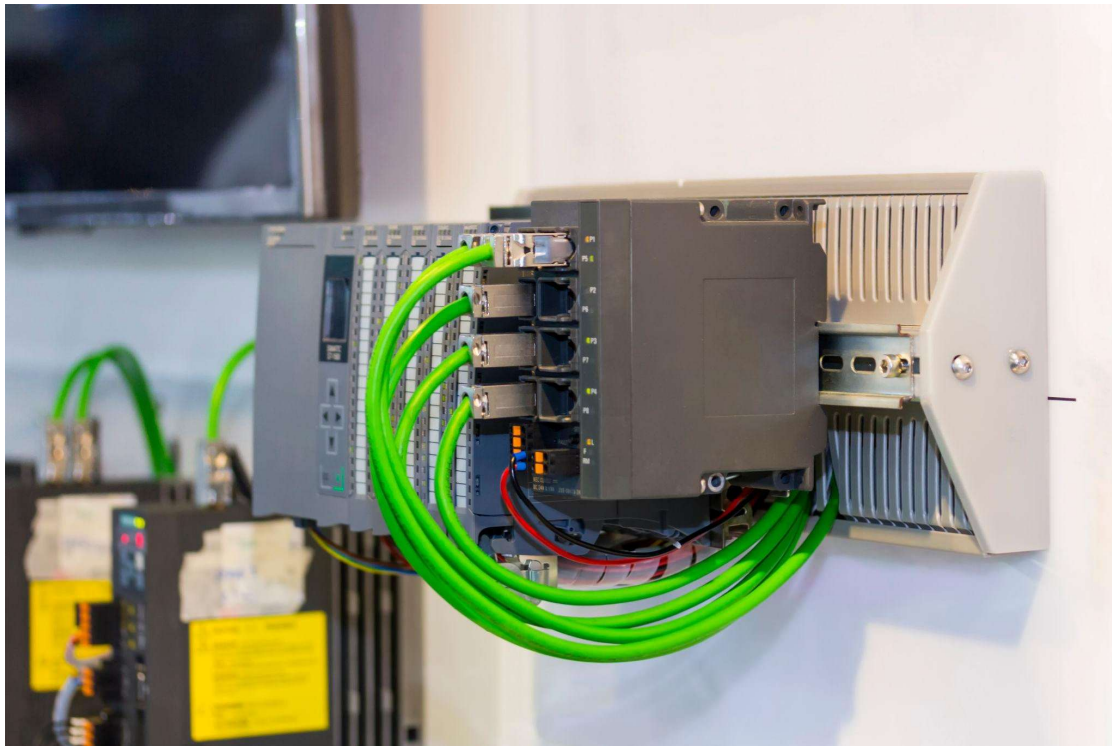
Εικόνα 1.2 - PLC υψηλής ακρίβειας για έλεγχο μηχανών ή διαδικασιών παραγωγής σε βιομηχανικές εφαρμογές
