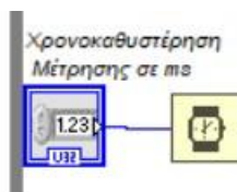
Εικόνα 2.7 :Block Diagram – Εισαγωγή χρονοκαθυστέρησης μεταξύ των μετρήσεων.
