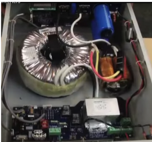
Σχήμα 3.10: Αντιστροφείς με και δίχως Μετασχηματιστή
