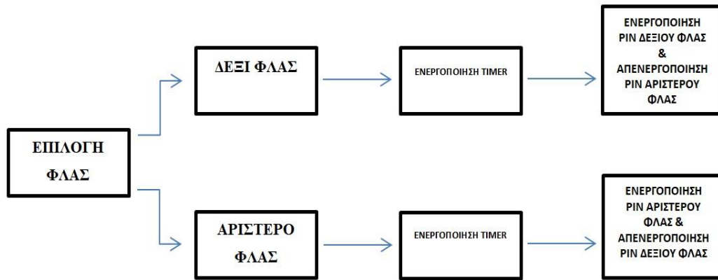
Εικόνα 32 Μπλοκ διάγραμμα για τον κώδικα των φλας
