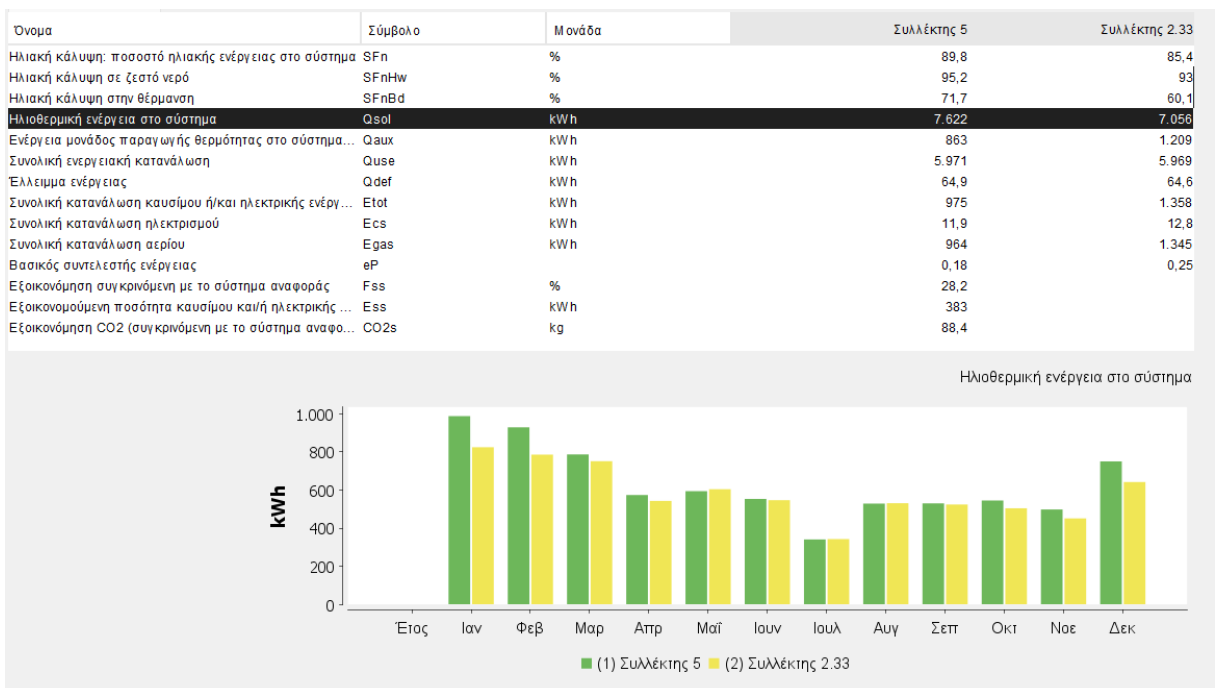
Σχήμα 5.4 : Η Ηλιοθερμική ενέργεια στα δύο συστήματα
