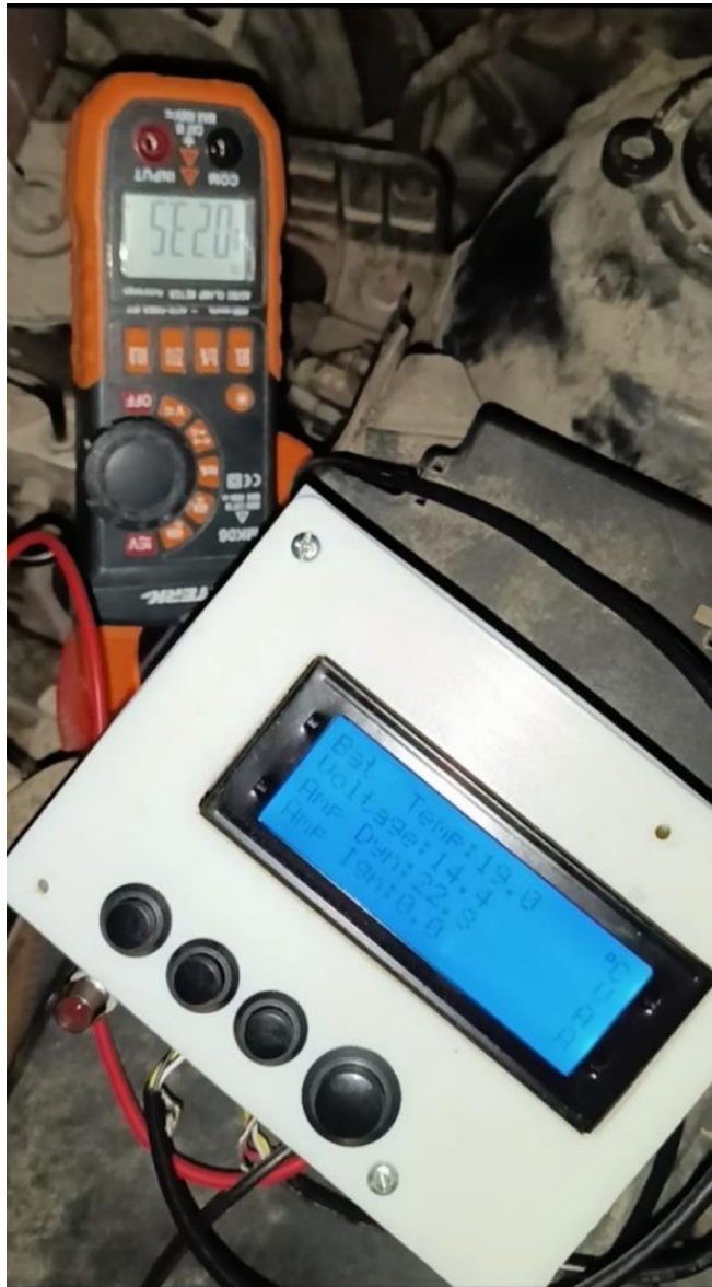
Εικόνα 33: Μέτρηση ρεύματος δυναμό με ενεργά τα φωτά πορείας του αυτοκινήτου
