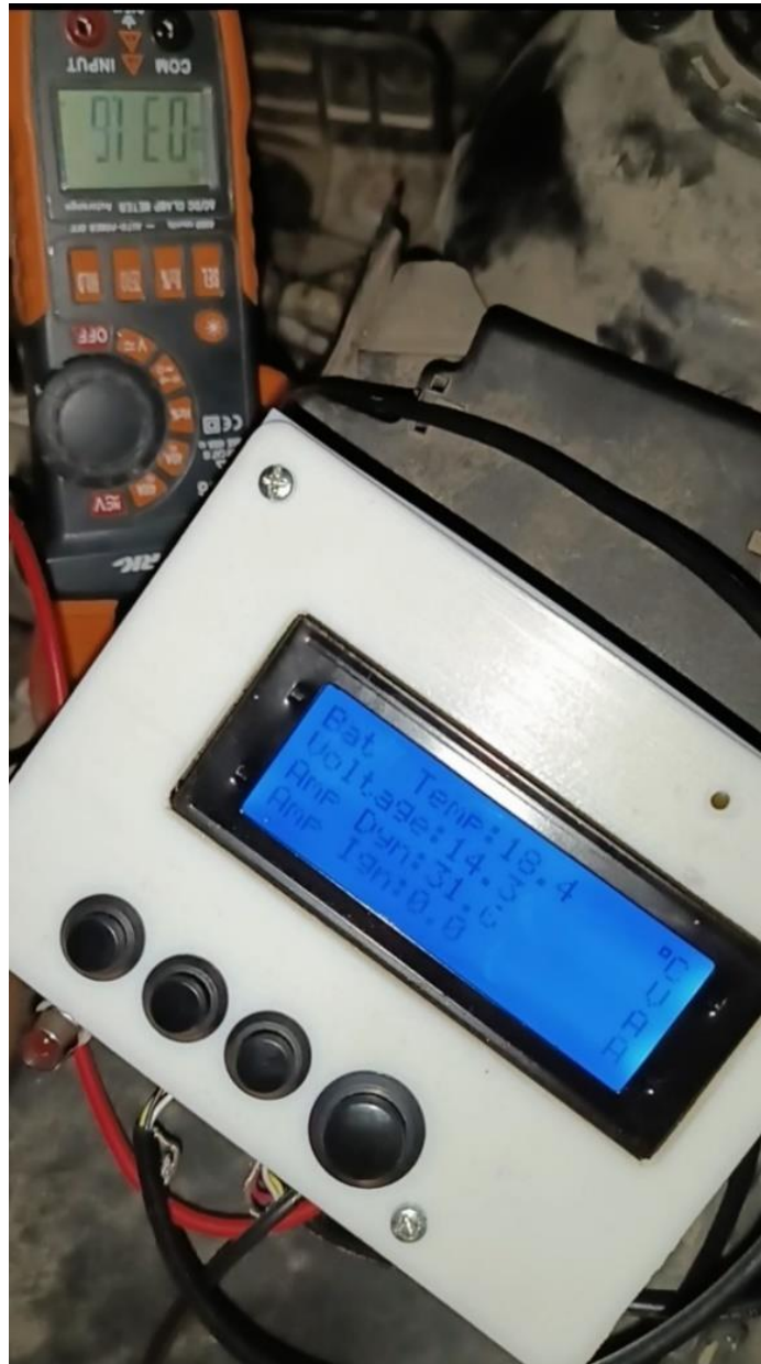
Εικόνα 34: Μέτρησης ρεύματος δυναμό με ανοιχτά τα μεγάλα φωτά
