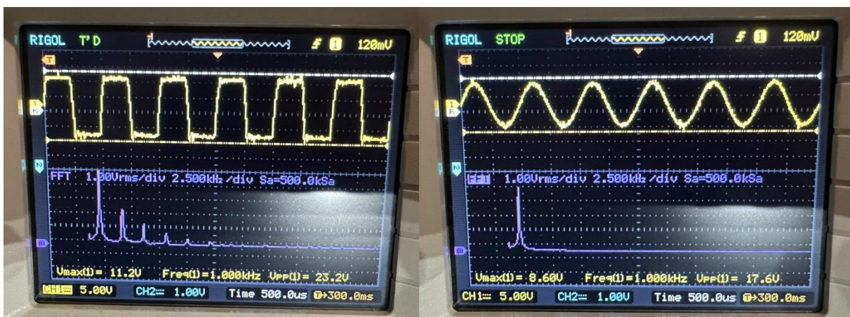
Εικόνα 3.10: Μέτρηση ολικής παραμόρφωσης & σήματος FFT με ψαλιδισμό και σωστή μέτρηση ολικής παραμόρφωσης & σήματος FFT.
