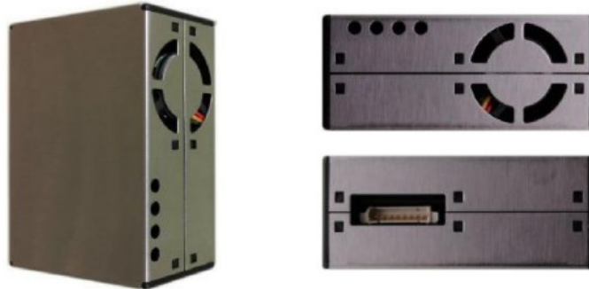
Σχήμα 3.18: Αισθητήρας σκόνης λέιζερ PLANTOWER PMS5003 [61]
