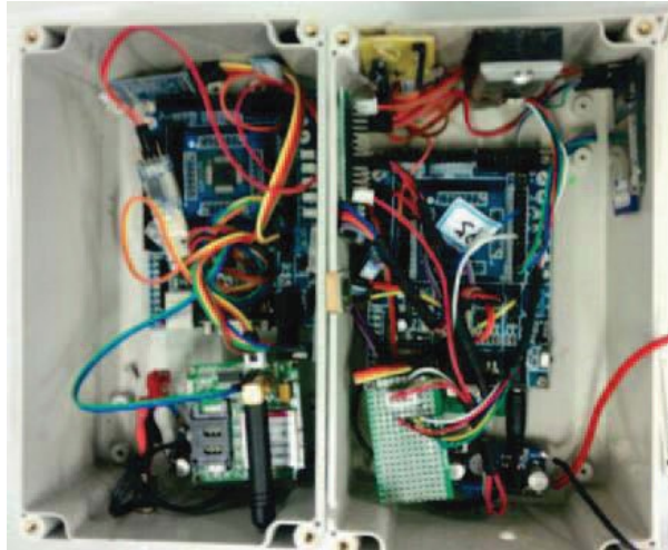
Σχήμα 5.83: Το ολοκληρωμένο σύστημα παρακολούθησης που χρησιμοποιείται σε κάθε ποδήλατο [149]
