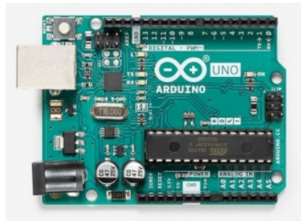
Σχήμα 3.22: Παράδειγμα πλακέτας Arduino (μοντέλο Arduino UNO REV3) [69]
