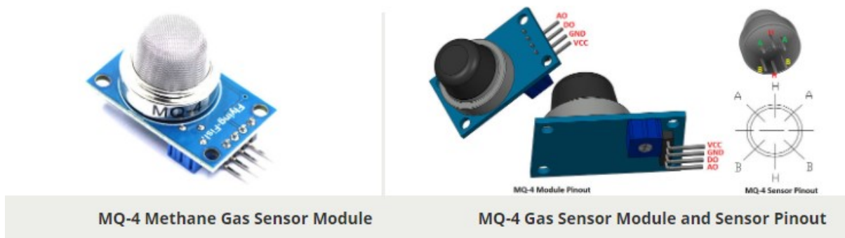
Σχήμα 3.21: Μονάδα αισθητήρα όζοντος MQ-4 (αριστερά) και αντίστοιχο pinout του ίδιου αισθητήρα και της μονάδας (δεξιά) [67]
