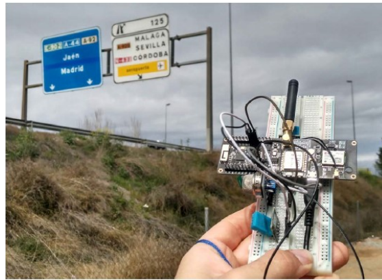
Σχήμα 5.63: Συνεργατικό δίκτυο αισθητήρων βασισμένο στο πρωτόκολλο LoRa για παρακολούθηση της ρύπανσης σε «έξυπνες πόλεις» [139]
