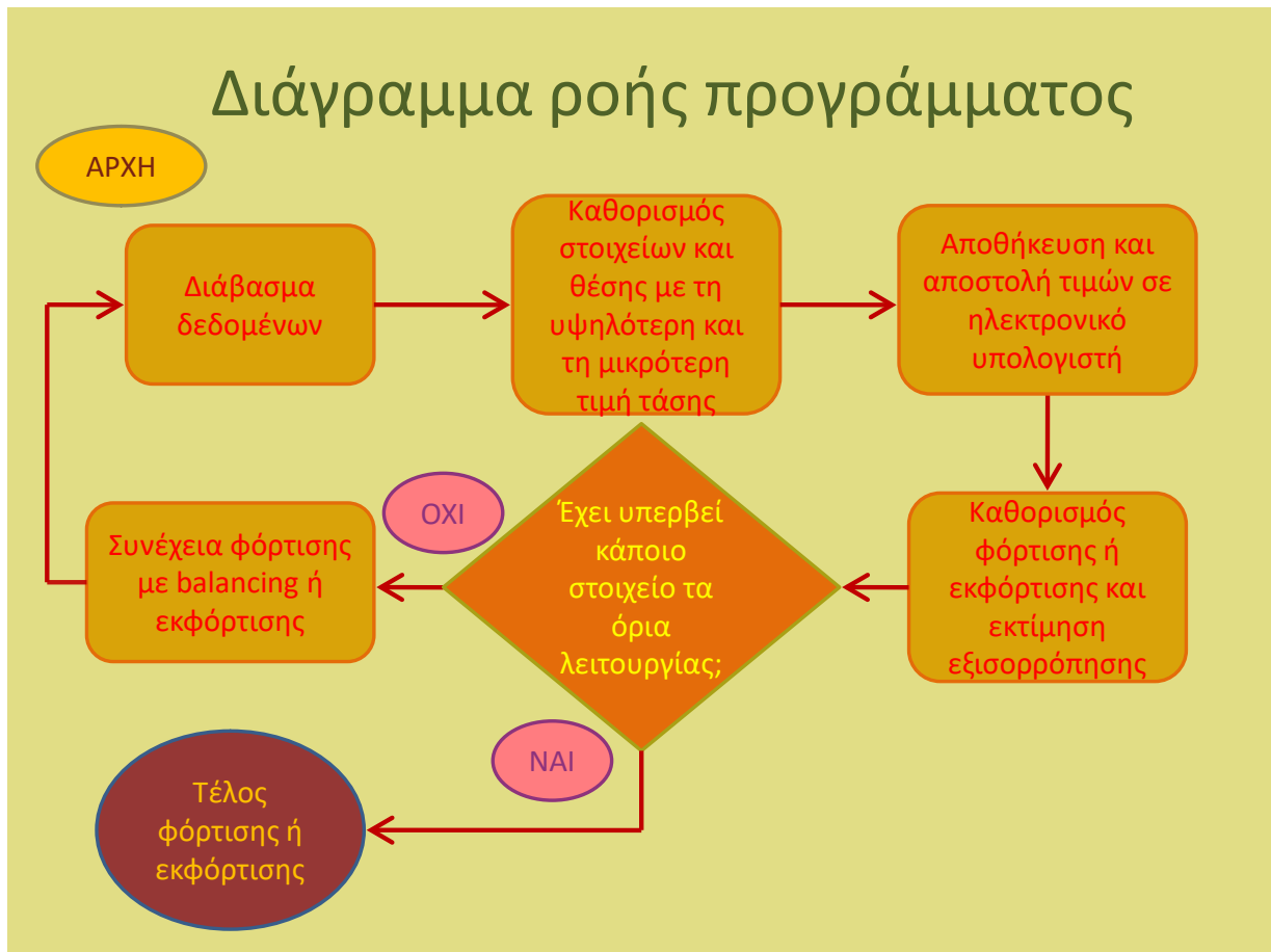
Σχήμα 4.11: Διάγραμμα ροής του προγράμματος με έλεγχο των ορίων λειτουργίας των στοιχείων.
