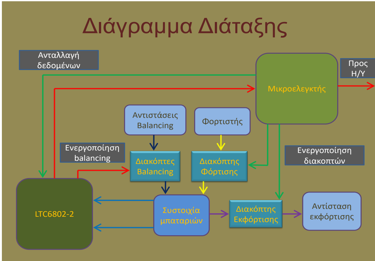
Σχήμα 4.3: Block διάγραμμα που απεικονίζει όλα τα μέρη του συστήματος και τις αλληλεπιδράσεις μεταξύ τους.
