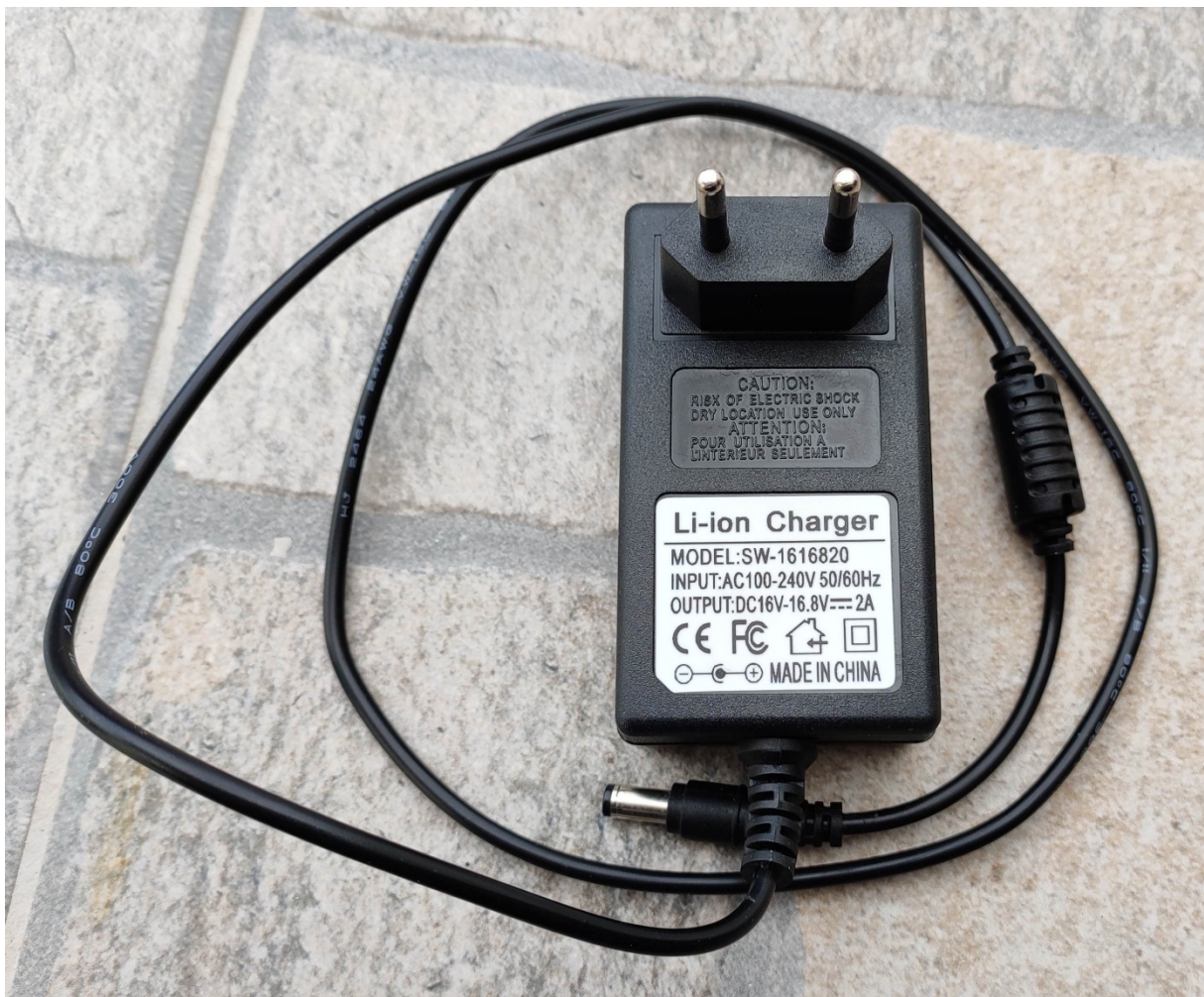
Σχήμα 4.4: Ο φορτιστής που χρησιμοποιήθηκε για την φόρτιση της συστοιχίας.
