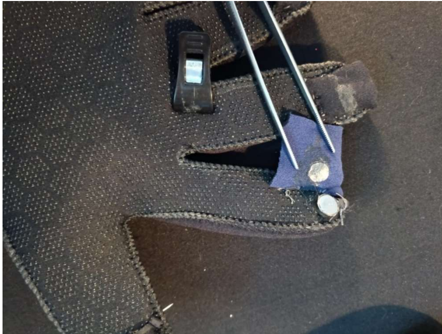
Εικόνα 50. Τοποθέτηση δονητικού ενεργοποιητή (Vibrator Motor) στην άκρη του δακτύλου.
