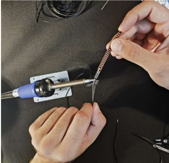
Εικόνα 47. Κόλληση ηλεκτρονικών συνδέσεων αισθητήρα Flex sensor.
