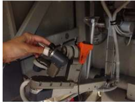
Εικόνα 9. Λαβή da Vinci master με προσαρμοσμένο ενεργοποιητή για απτική απεικόνιση των δονήσεων του εργαλείου [20].
