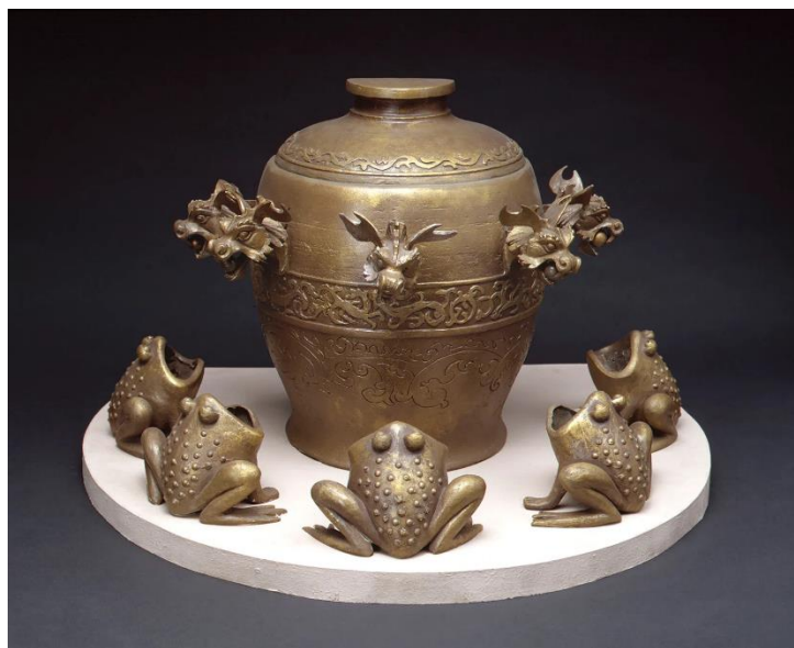
Εικόνα 4.1: Σεισμοσκόπιο Zhang Heng [11]
