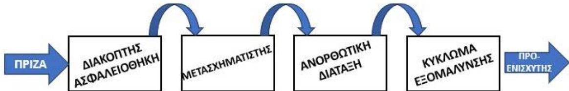
Σχήμα 4.1: Μπλοκ διάγραμμα κυκλώματος τροφοδοσίας ενισχυτή ήχου
