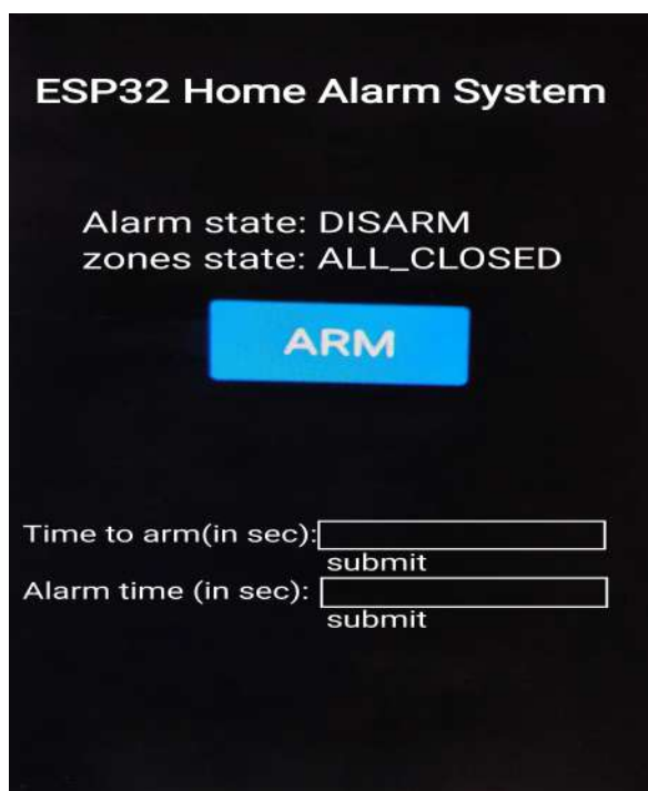
Εικόνα 4.50 Interface του συναγερμού απο το κινητό
