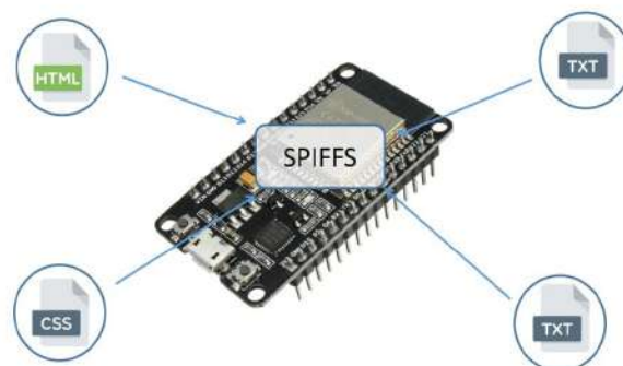
Εικόνα 4.39 Σύστημα SPIFFS για την αποθήκευση αρχείων στο ESP32
