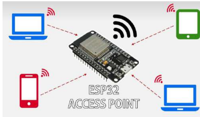
Εικόνα 4.40 ESP32 σε λειτουργία access point
