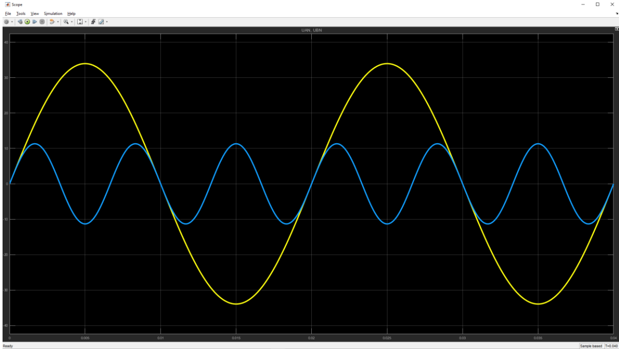
Σχήμα 10. Ιδανικό σήμα κιθάρας μονοπηνιακού μαγνήτη, και φαινόμενο hum
