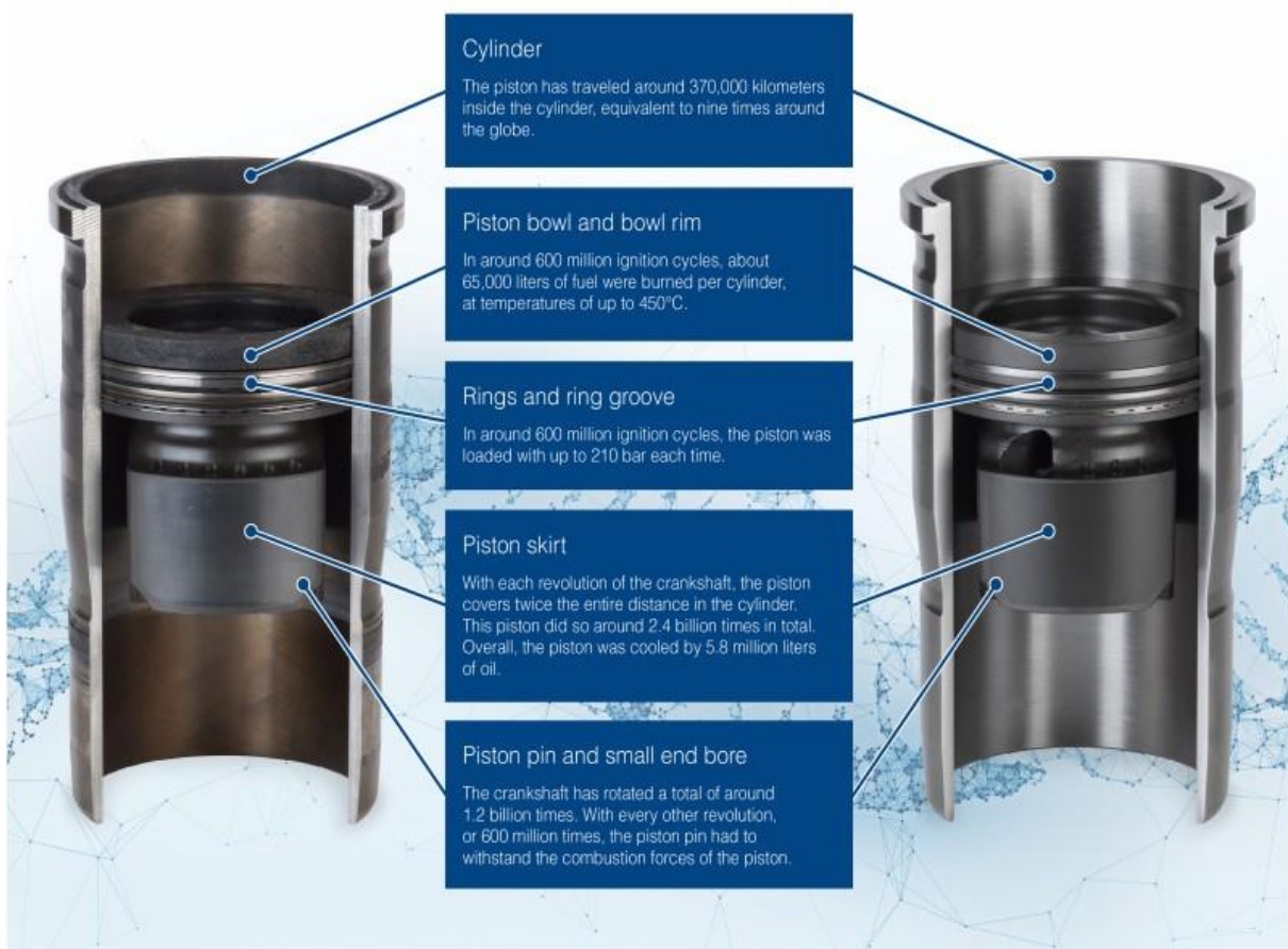
Εικόνα 3-5: Δομή ενός τυπικού συστήματος εμβόλου [24].
