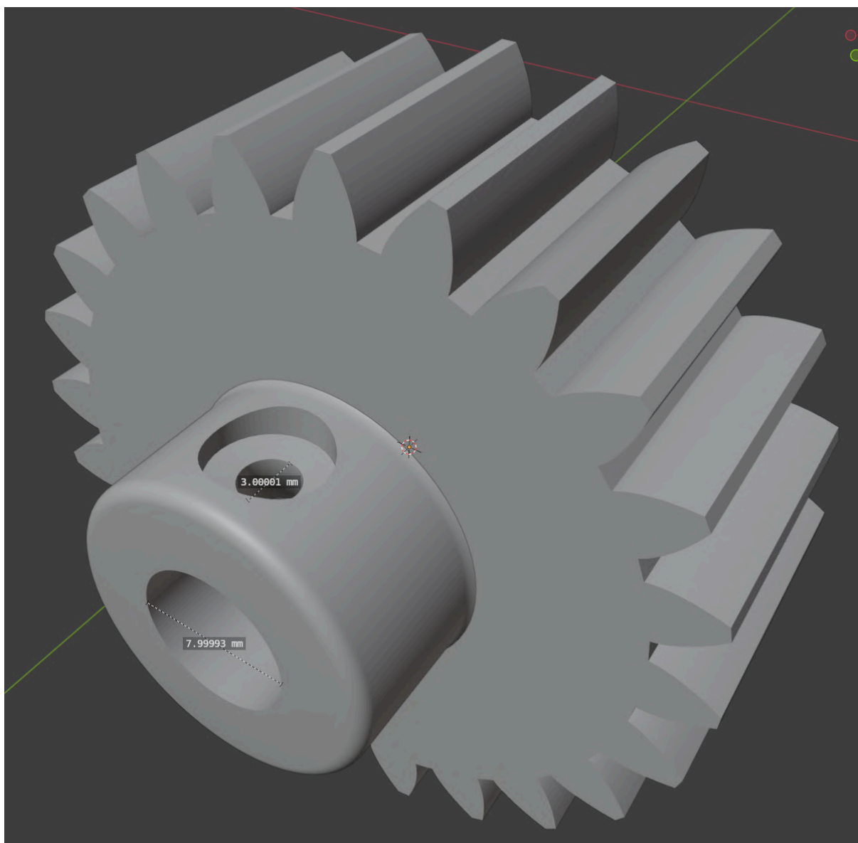
Σχήμα 2.3.1.2: Μηχανισμός στερέωσης οδοντωτού τροχού σε άξονα
