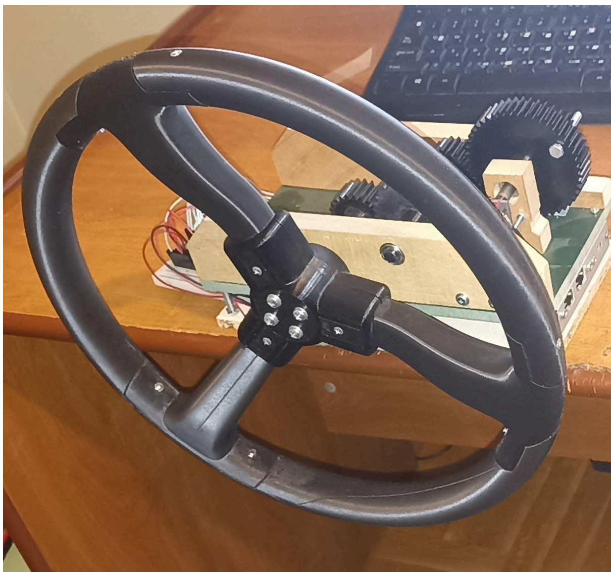
Σχήμα 2.3.1.8: Τελική υλοποίηση υποσυστήματος τιμονιού
