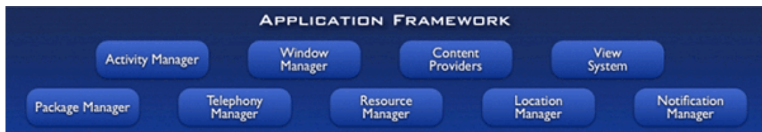
Εικόνα 2.10: Android Operating System Application Framework Layer
