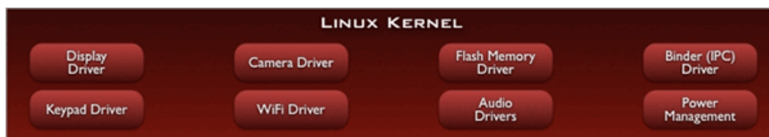
Εικόνα 2.13: Linux kernel in Android Operating System
