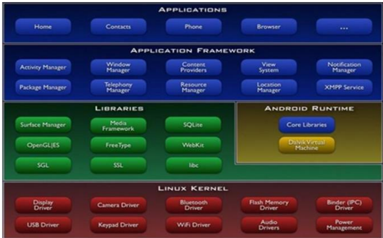
Εικόνα 2.8: Τα επίπεδα (layers) του λειτουργικού συστήματος Android
