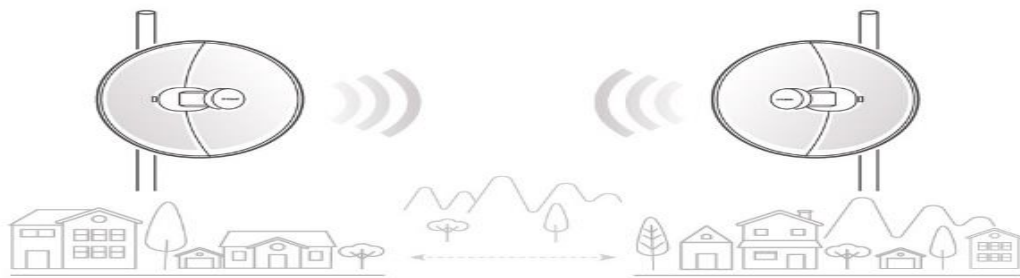
Σχήμα 3-2: Ζεύξη point-to-point με χρήση κατευθυντικών κεραιών [55]
