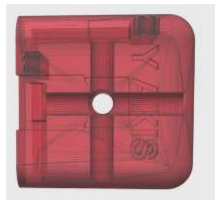
Σχήμα 3.10 Διαμπερή εικόνα αγωγών αέρα, για την παθητική ψύξη των αισθητήρων
