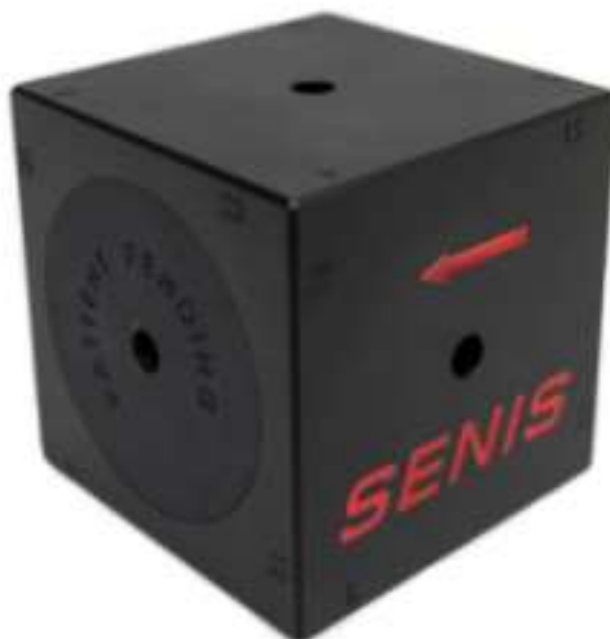
Σχήμα 8.1: Μαγνήτης αναφοράς για ρύθμιση αισθητήρων
