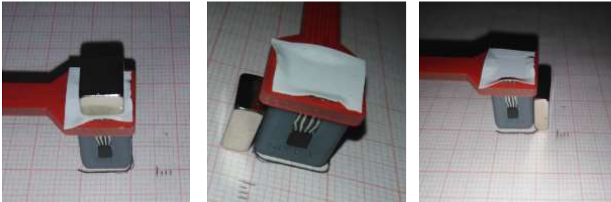
Σχήμα 8.8 : Εικόνες κατά την διάρκεια μετρήσεων. Η άσπρη ταινία τοποθετήθηκε στον αισθητήρα Y για να μην βραχυκυκλώσουν τα pin του αισθητήρα όταν ακουμπάει επάνω του ο μαγνήτης
