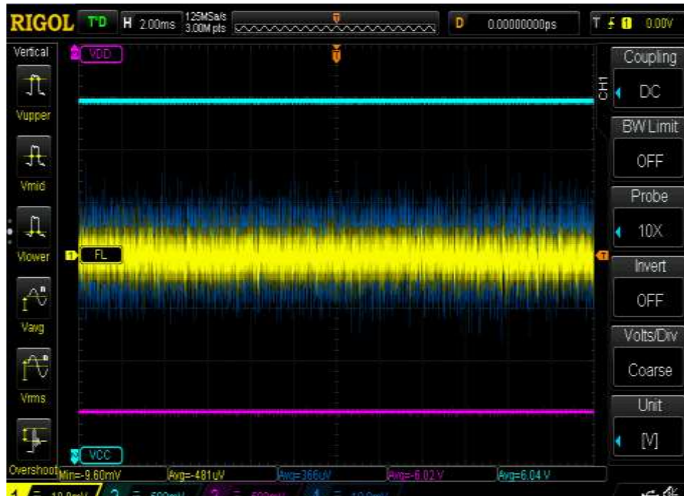
Σχήμα 4.13: Απεικόνιση τάσης (κίτρινο χρώμα) στην έξοδο της βαθμίδας του φίλτρου σε κατάσταση ηρεμίας. Η τάση ανέρχεται στα -481\mu V . Με το κίτρινο και το μπλε απεικονίζονται οι τάσεις τροφοδοσίας των αισθητήρων.
