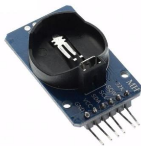
Εικόνα 3.4: Real Time Clock Module I2C - DS3231
