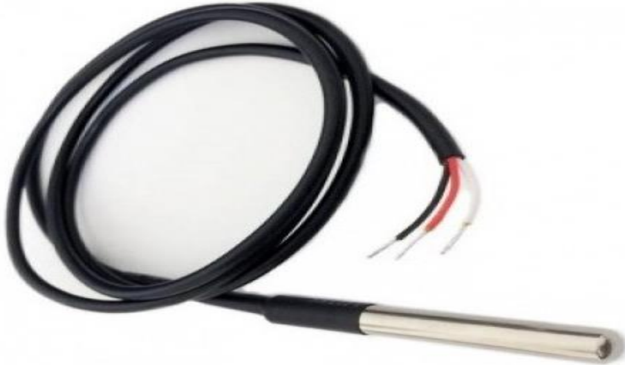
Εικόνα 2.18: Temperature Sensor – Waterproof (DS18B20)
