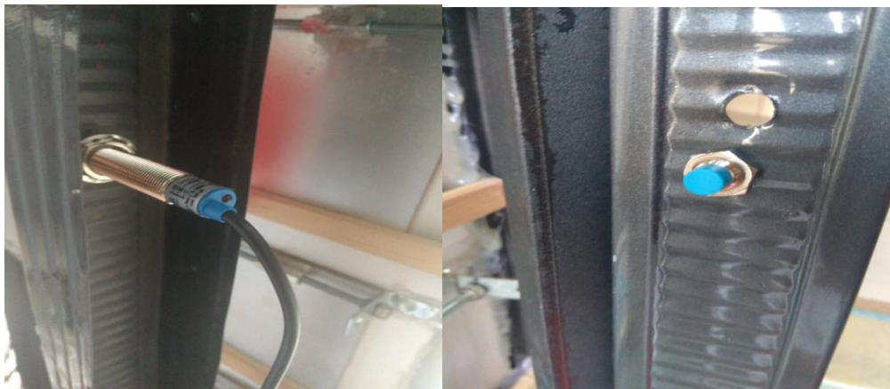
Σχήμα 5.15 Επαγωγικοί αισθητήρες θέσης
