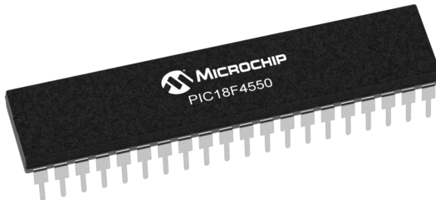
Σχήμα 3.1 Μικροελεγκτής PIC 18F44550 της Microchip
