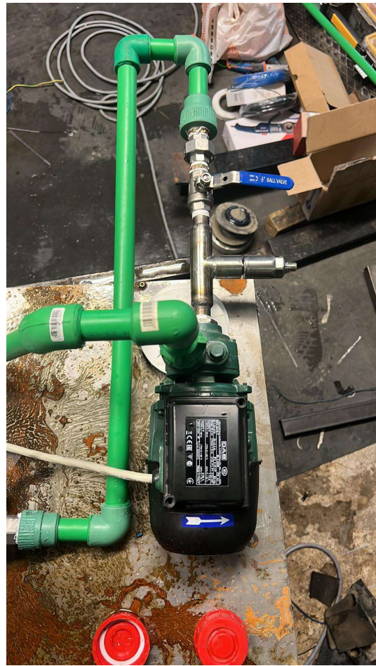
Εικόνα 4.4. και 4.5 Αντλία παροχής νερού και φωτοκύτταρο ένδειξης ύπαρξης νερού στο κύκλωμα
