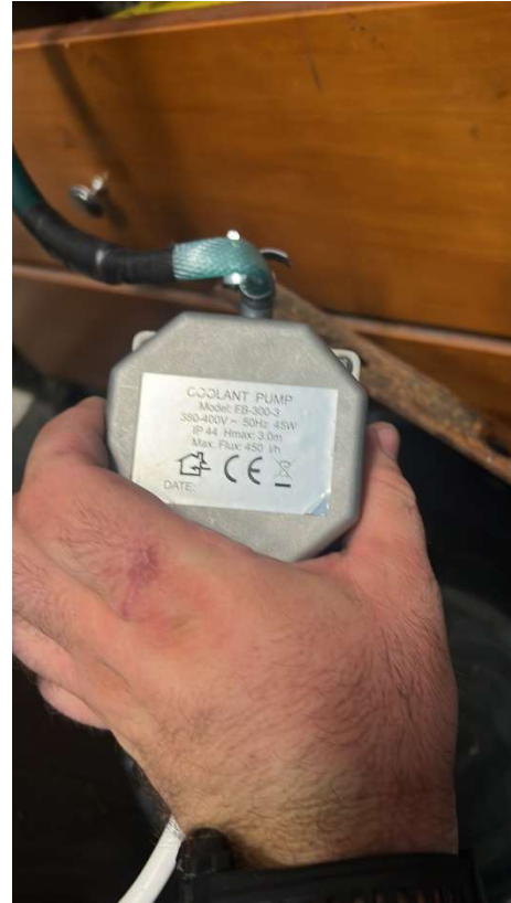
Εικόνα 4.10. & Εικόνα 4.11. Αντλία ψύξης που χρησιμοποιείται σαν δυναμό
