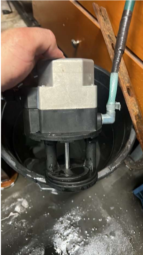
Εικόνα 4.10. & Εικόνα 4.11. Αντλία ψύξης που χρησιμοποιείται σαν δυναμό
