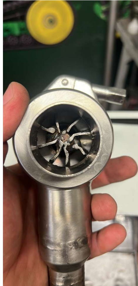
Εικόνα 4.13 & Εικόνα 4.14. Πειραματικός υδροστρόβιλος τύπου Francis - τουρμπίνα (αλλά όχι με 100% ακρίβεια γιατί η πρωτότυπη έχει μεταβλητά πτερύγια)
