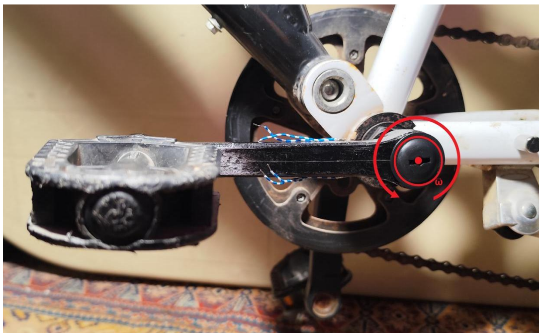
Εικόνα 2.1: Απεικόνιση γωνιακής ταχύτητας στο βραχίονα
