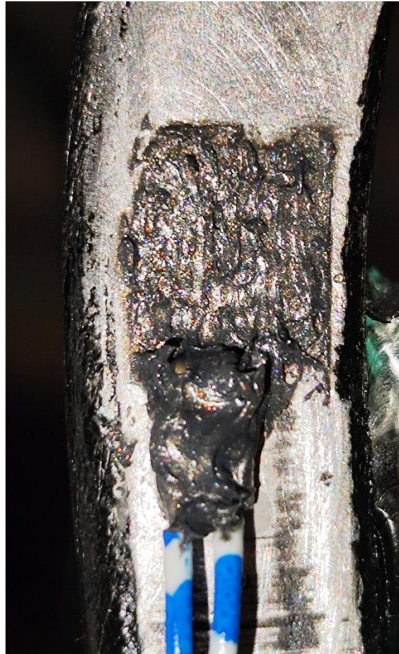
Εικόνα 5.13: Strain gauge επικαλυμμένο με σιλικόνη
