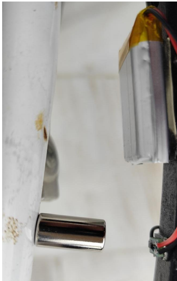
Εικόνα 5.19: Αισθητήρας Hall απέναντι από τον μαγνήτη
