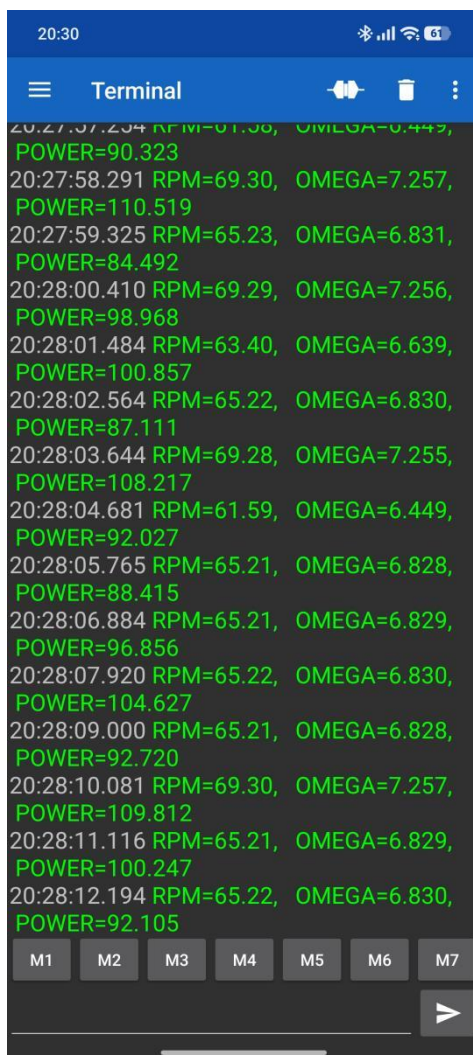
Εικόνα 6.7: Μέτρηση στροφών, ταχύτητας και μηχανικής ισχύος
