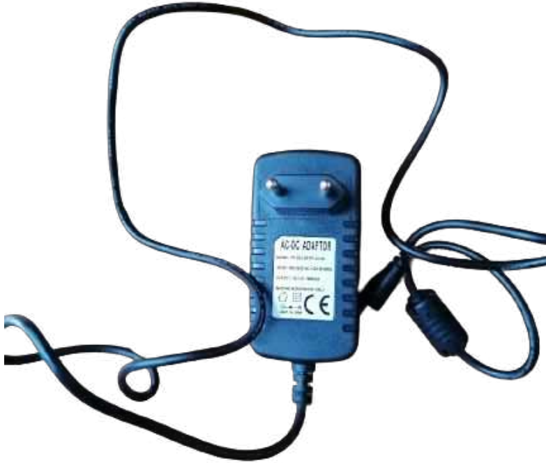
Εικόνα 14: Μετασχηματιστής 220V σε 12V.
