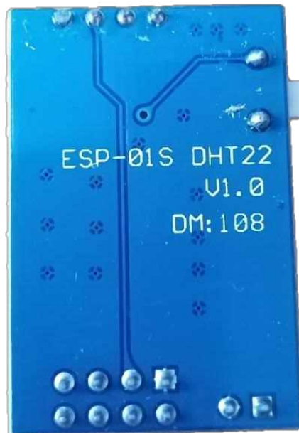
Εικόνα 3: Οπίσθια όψη DHT22 με ενσωματωμένες διεπαφές και κύκλωμα τροφοδοσίας.
