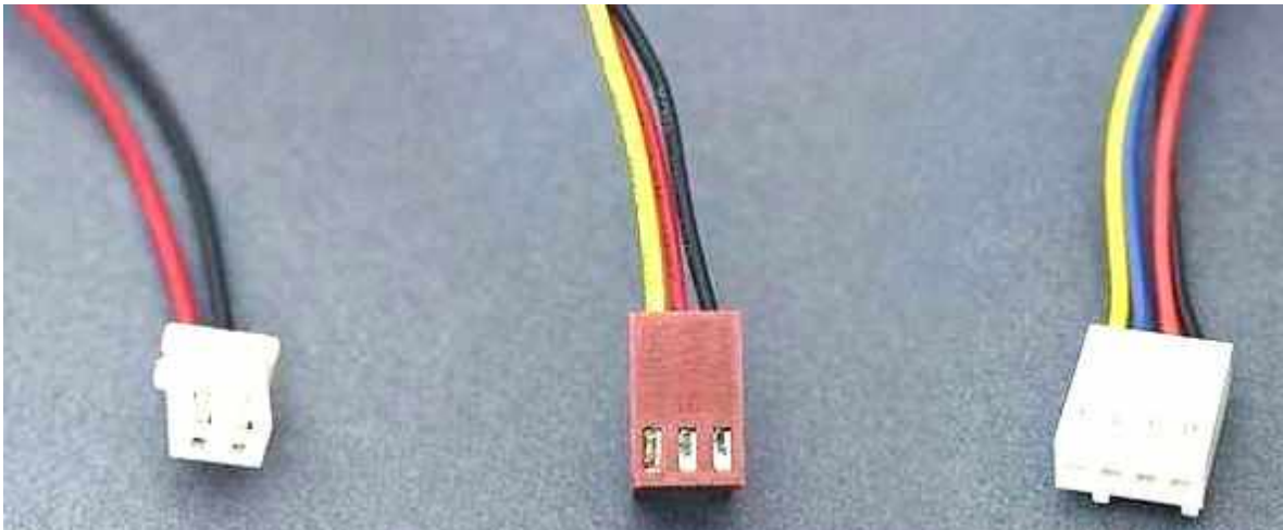
Εικόνα 18: Είδη ανεμιστήρων (από αριστερά προς τα δεξιά: 2pin, 3pin, 4pin) (Πηγή 13).
