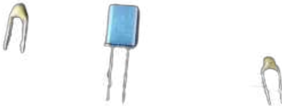
Εικόνα 22: Κρύσταλλος 16MHz με 2 πυκνωτές 22pF.
