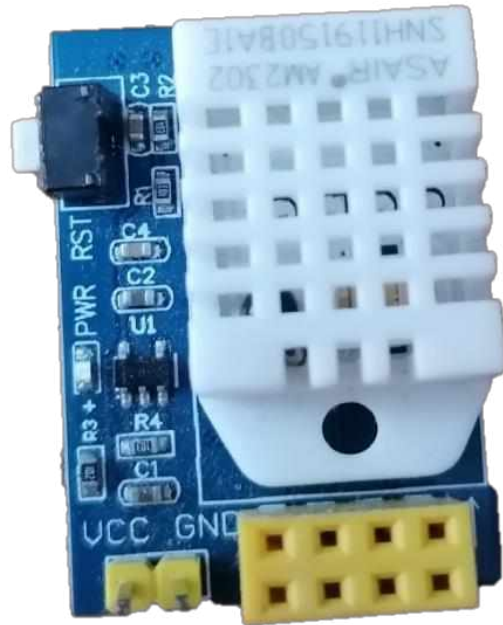
Εικόνα 2: Εμπρόσθια όψη DHT22 με ενσωματωμένες διεπαφές και κύκλωμα τροφοδοσίας.
