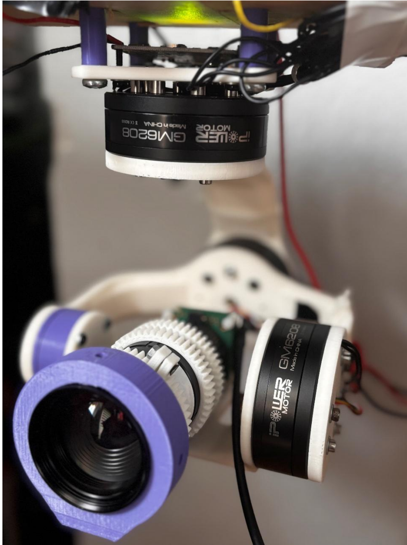
Εικόνα 48 Gimbal με τροφοδοσία σε κανονική κατάσταση
