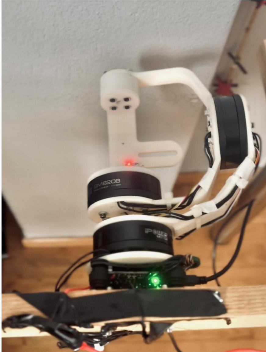
Εικόνα 46 Δοκιμή PID σε κατάσταση Hold Yaw 90 μοιρών χωρίς φορτίο-κάμερα
