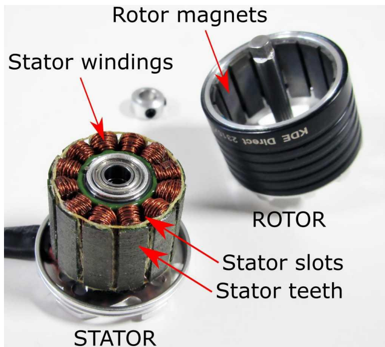
Εικόνα 20 Αναπαράσταση του στάτορα και ρότορα [44]
