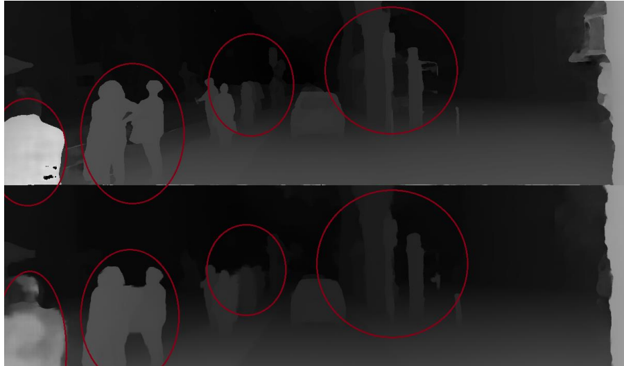
Σχήμα 5.37: Σύγκριση μεταξύ των εκτιμήσεων του HITNet (πάνω) και του Fast-ACVNet (κάτω) βάσει της δεύτερης φωτογραφίας από το Σχήμα 5.35.
