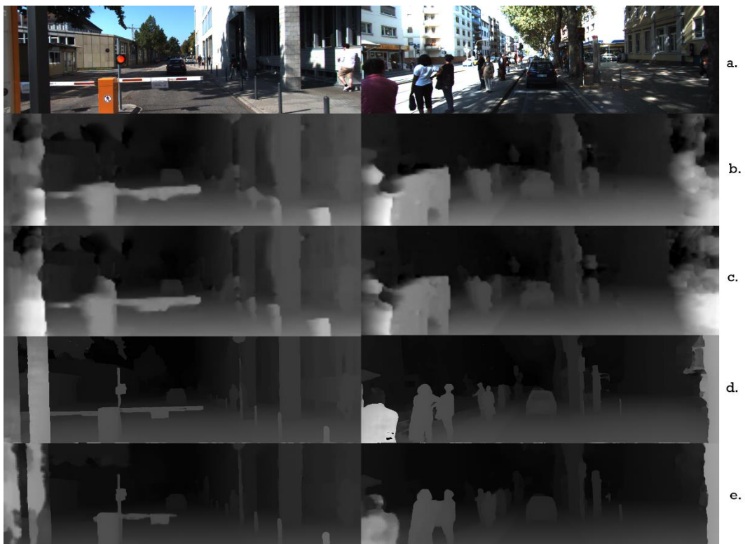
Σχήμα 5.35: Σύγκριση πηγαίων φωτογραφιών από το dataset KITTI 2015 (a.) και οι αντίστοιχες εκτιμήσεις των μοντέλων UnOS (b,c), HITNet (d) και Fast-ACVNet (e) (2) – Δρόμος μεγάλης πυκνότητας αντικειμένων.
