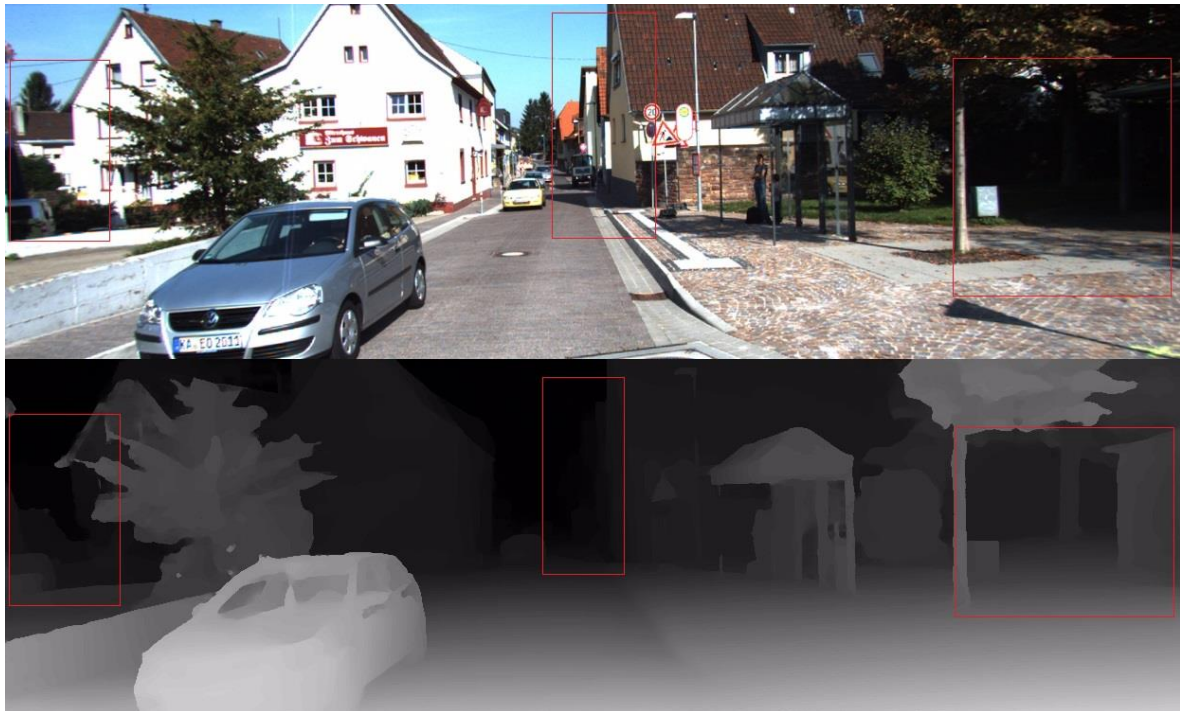
Σχήμα 5.16: Πηγαία φωτογραφία από το KITTI 2015 (πάνω) και η αντίστοιχη εκτίμηση του HITNet (κάτω) με σημειωμένες κύριες λεπτομέρειες.
