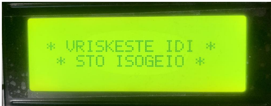
Εικόνα 28. Οθόνη θέσης θαλάμου
