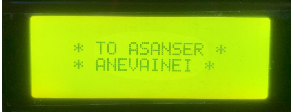
Εικόνα 26. Οθόνη για την κατάσταση του θαλάμου
