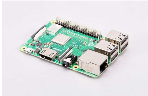
Σχήμα 1.1 Πλατφόρμα προτυποποίησης Raspberry Pi 3B+
