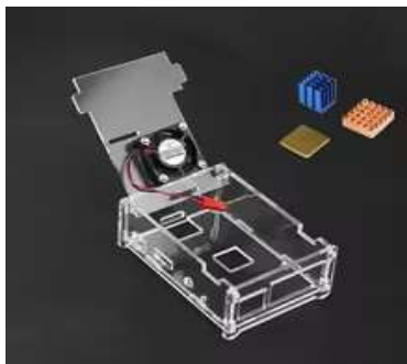
Σχήμα 2.8 Κιτ προστασίας και ενεργής ψύξης της πλατφόρμας
