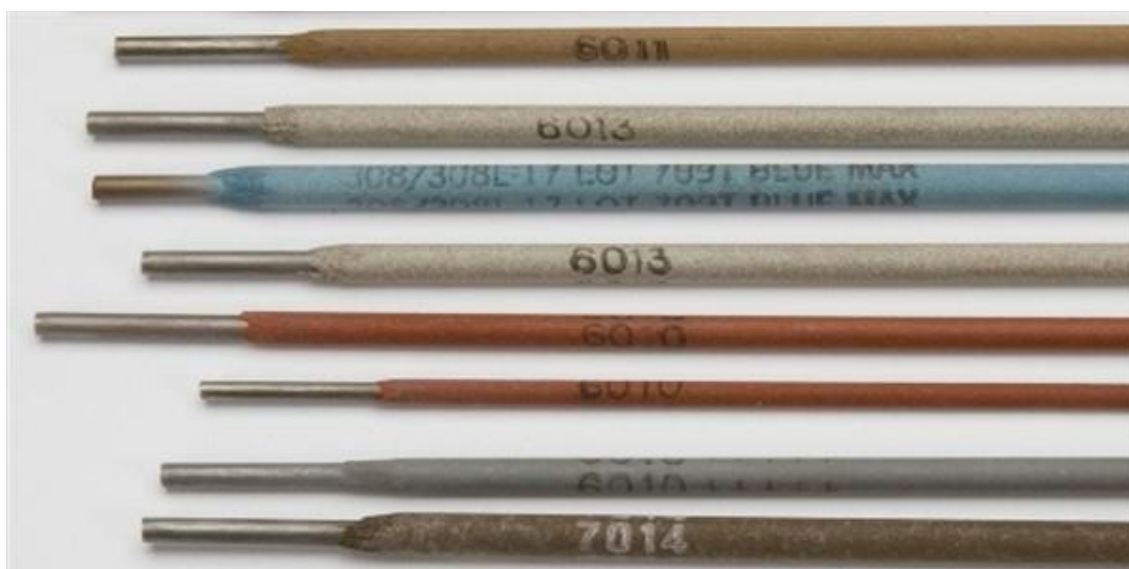
Εικόνα 1.18: Διάφοροι τύποι ηλεκτροδίων MMA
