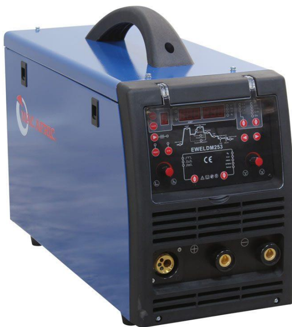
Εικόνα 1.8: Μηχανή ηλεκτροσυγκόλλησης MIG/MAG
