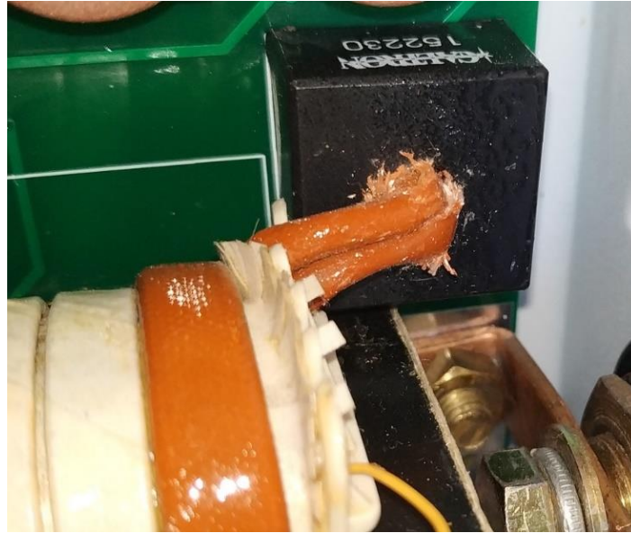
Εικόνα 3.8: Τρόπος σύνδεσης μετασχηματιστή ρεύματος
