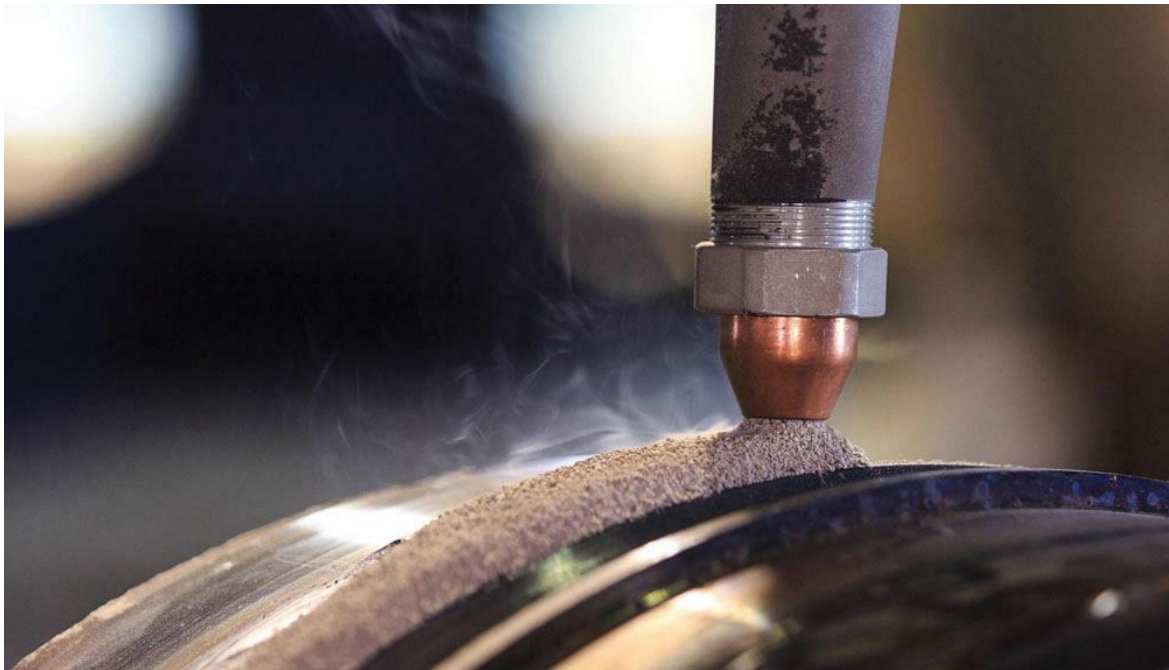
Εικόνα 1.14: Διαδικασία ηλεκτροσυγκόλλησης SAW
