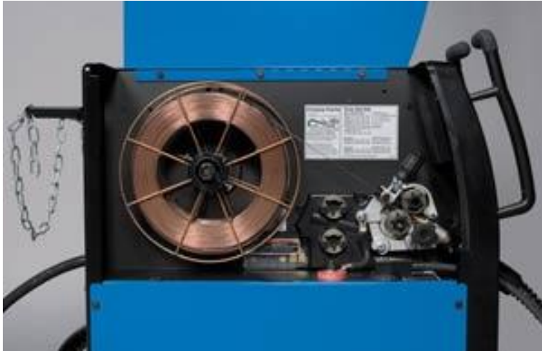
Εικόνα 1.9: Καρούλι αναλώσιμου σύρματος και μηχανισμός τροφοδότησης εσωτερικά της μηχανής MIG/MAG
