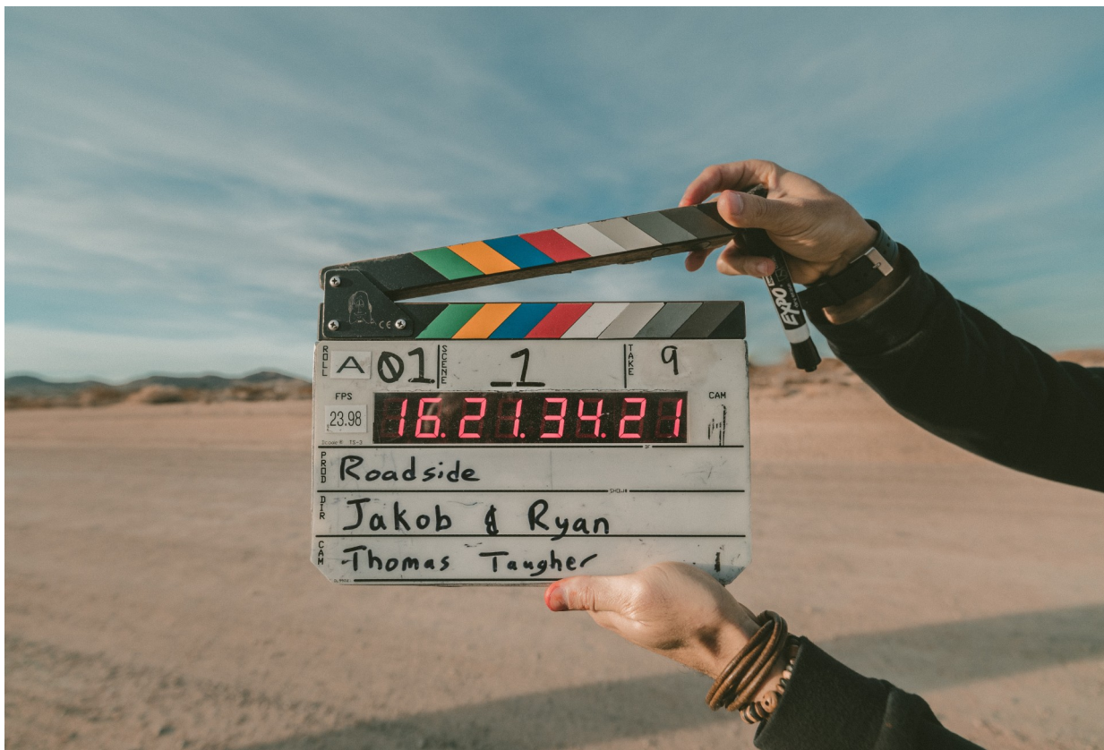
Εικόνα 9: Ηλεκτρονική κλακέτα συγχρονισμού εικόνας και ήχου
